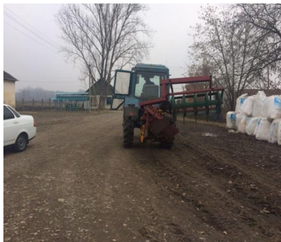
Рисунок 3.20 – Общий вид пахотно-фрезерного агрегата в транспортном положении
