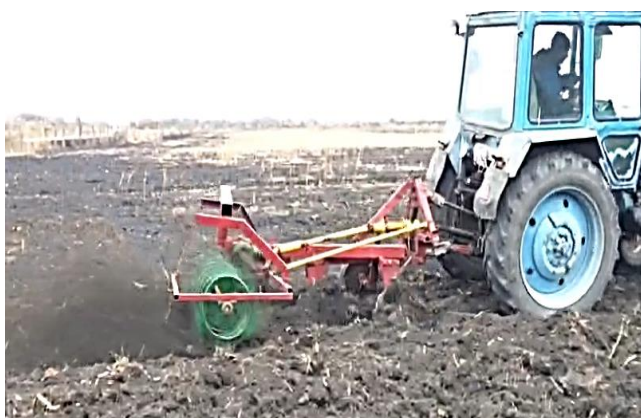
Риснок 3.21 – Вспашка почвы пахотно-фрезерным агрегатом (а) и поверхность поля после вспашки (б)
