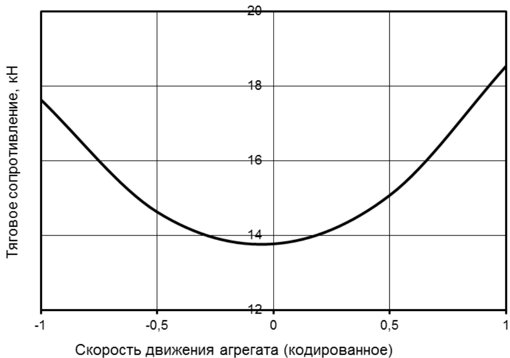
Рисунок 3.11 – График зависимости тягового сопротивления от скорости передвижения агрегата
