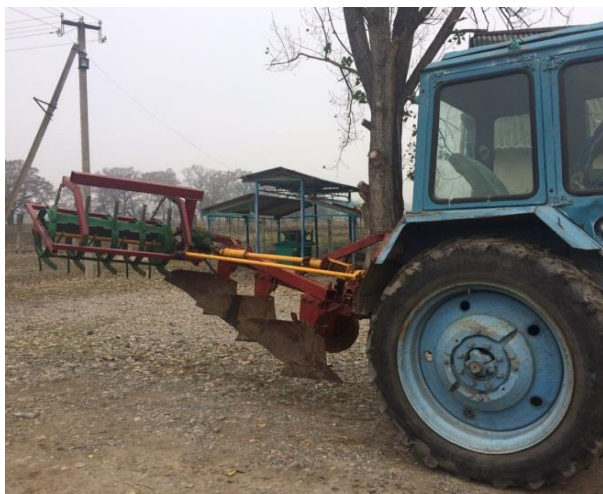
Рисунок 3.20 – Общий вид пахотно-фрезерного агрегата в транспортном положении
