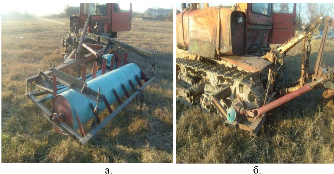
Рисунок 1.19 – Общий вид пахотного агрегата (а), привод ротационного рабочего органа от ведущей звездочки гусеничного трактора (б)
