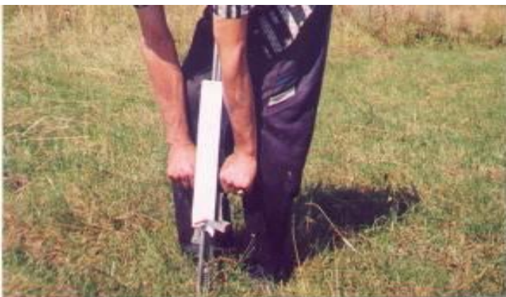
Рисунок 3. 4 – Твердомер Ревякина (а) и прибор для установления влажности почвы (б)
