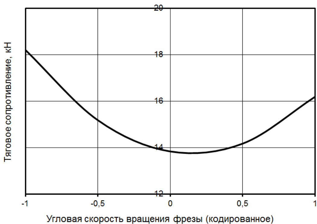
Рисунок 3.12 – График зависимости тягового сопротивления от угловой скорости вращения фрезы
