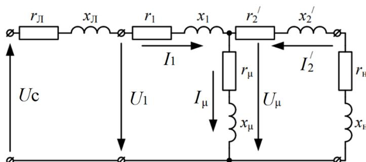
Рис. 1. Схема замещения одной фазы рассматриваемой системы электроснабжения
