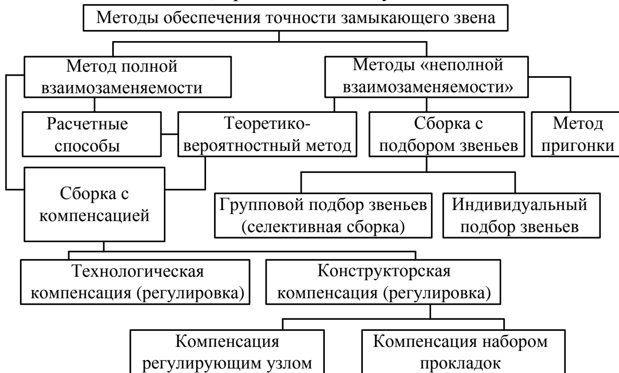
Рисунок 11.6 – Методы обеспечения точности замыкающего звена
