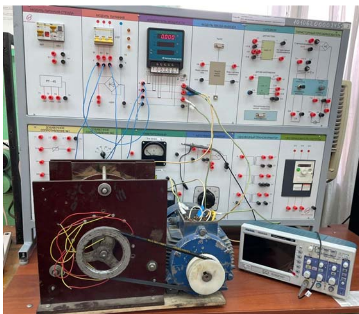
Рисунок 3.6 – Внешний вид лабораторного стенда для экспериментальных исследований натурной модели СДГУ мощностью 3 кВт
