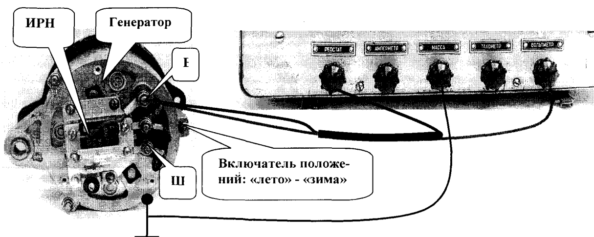
Рисунок 13 Схема проверки интегрального регулятора напряжений ИРН
