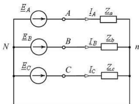
В изображенной схеме с симметричной системой ЭДС  $\underline{E}_A, \underline{E}_B, \underline{E}_C$  соотношение
