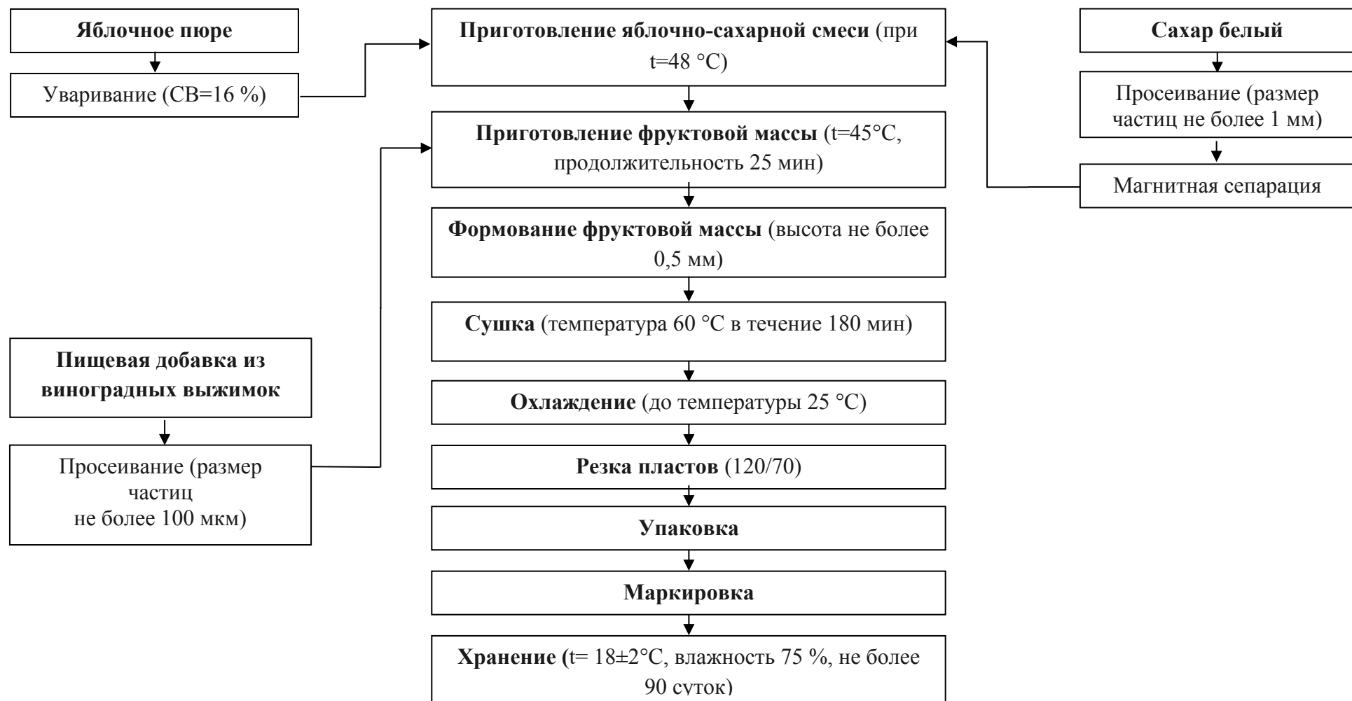
Рисунок 3.19 – Технологическая схема производства смоквы
