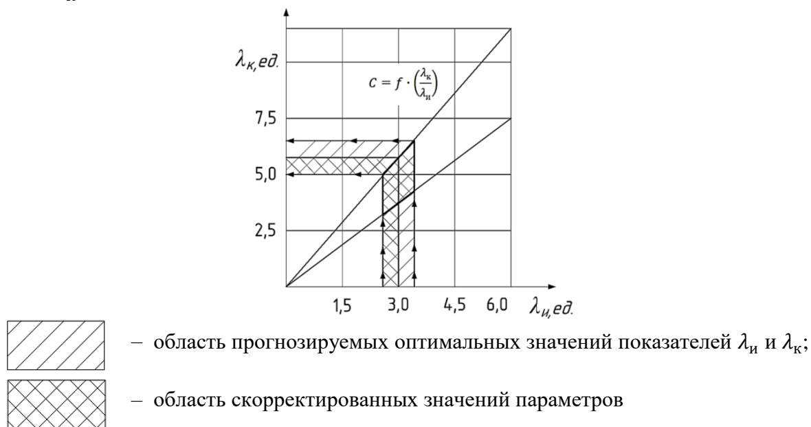
Рисунок 6 – Теоретическая зависимость, характеризующая соотношение – C = \lambda_{к}/\lambda_{и} , для установления их значений на стадии проектирования
