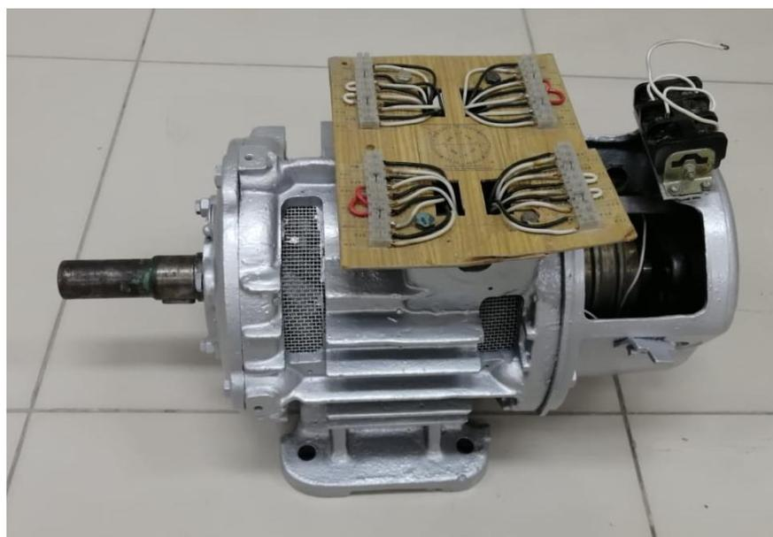
Рисунок 4.2 – ТВМП на асинхронном двигателе с фазным ротором
