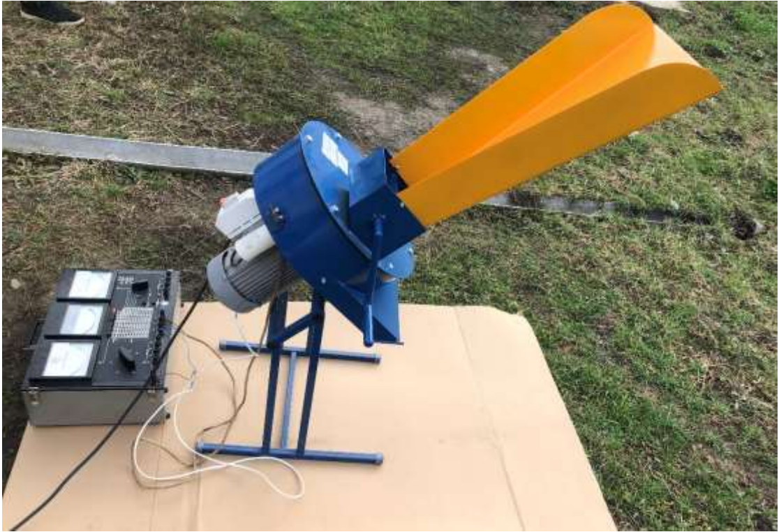
Рисунок 3.6 – Внешний вид экспериментальной установки измельчителя с рабочим органом молотково-сегментного типа
