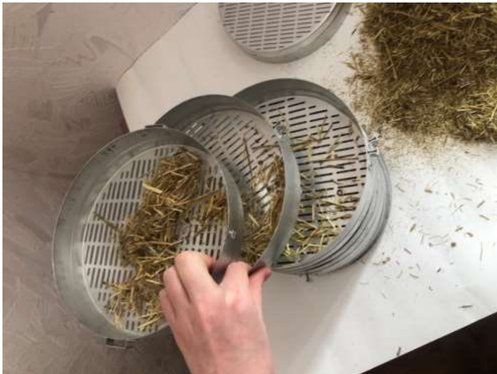
Рисунок 3.11 - Контроль изменения модуля помола корма фракций от 2 до 30 мм на решетном классификаторе
