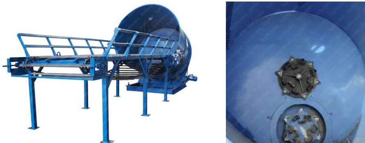
Рисунок 1.11 - Внешний вид измельчитель соломы ДПМС(Р)-22, измельчающий орган
