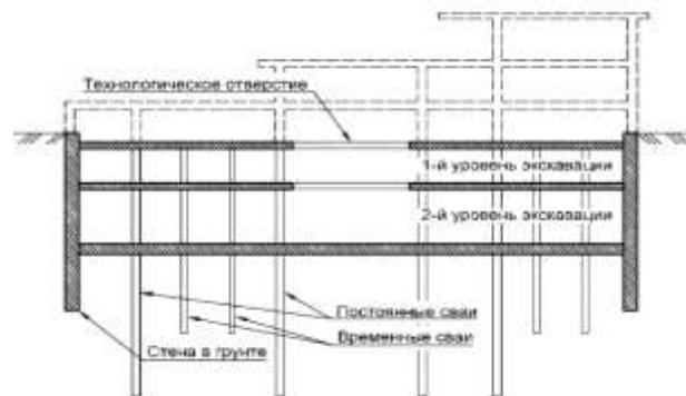
Рисунок 2.34 – Принципиальная схема технологии «top-down»
