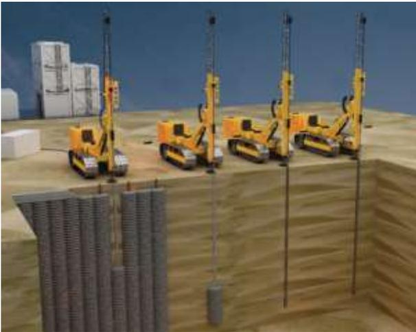
Рисунок 2.32 – Процесс выполнения грунтоцементных свай
