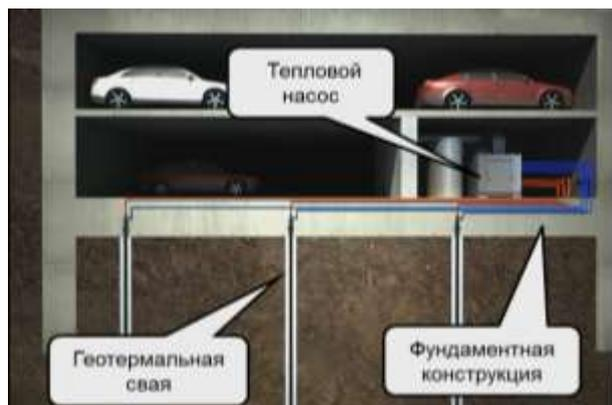
Рисунок 2.30 – Принципиальная схема свайно-плитного фундамента из геотермальных свай
