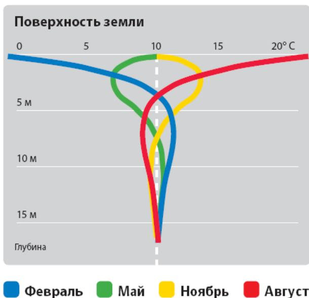
Рисунок 2.28 – График зависимости температуры грунта от глубины скважины в разное время года
