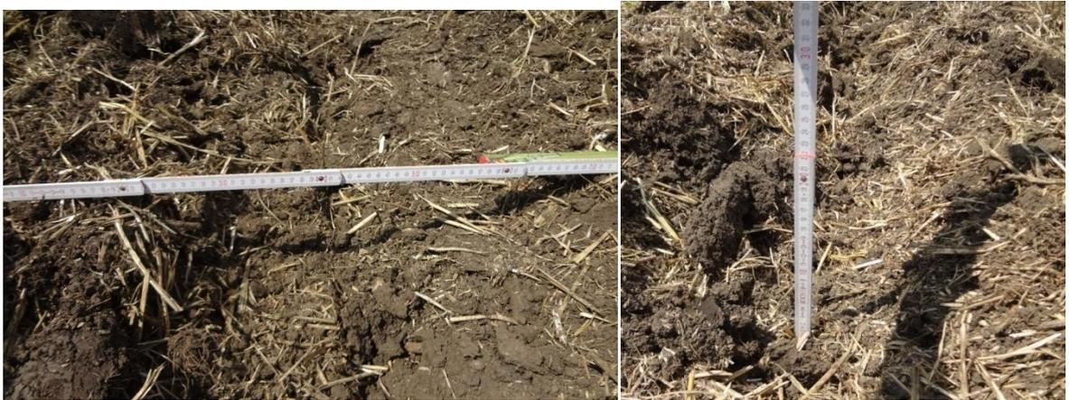
Рисунок 4.1 – Фиксация агротехнических показателей и агрофон после работы дисковых рабочих органов с изменяющимся радиусом кривизны
