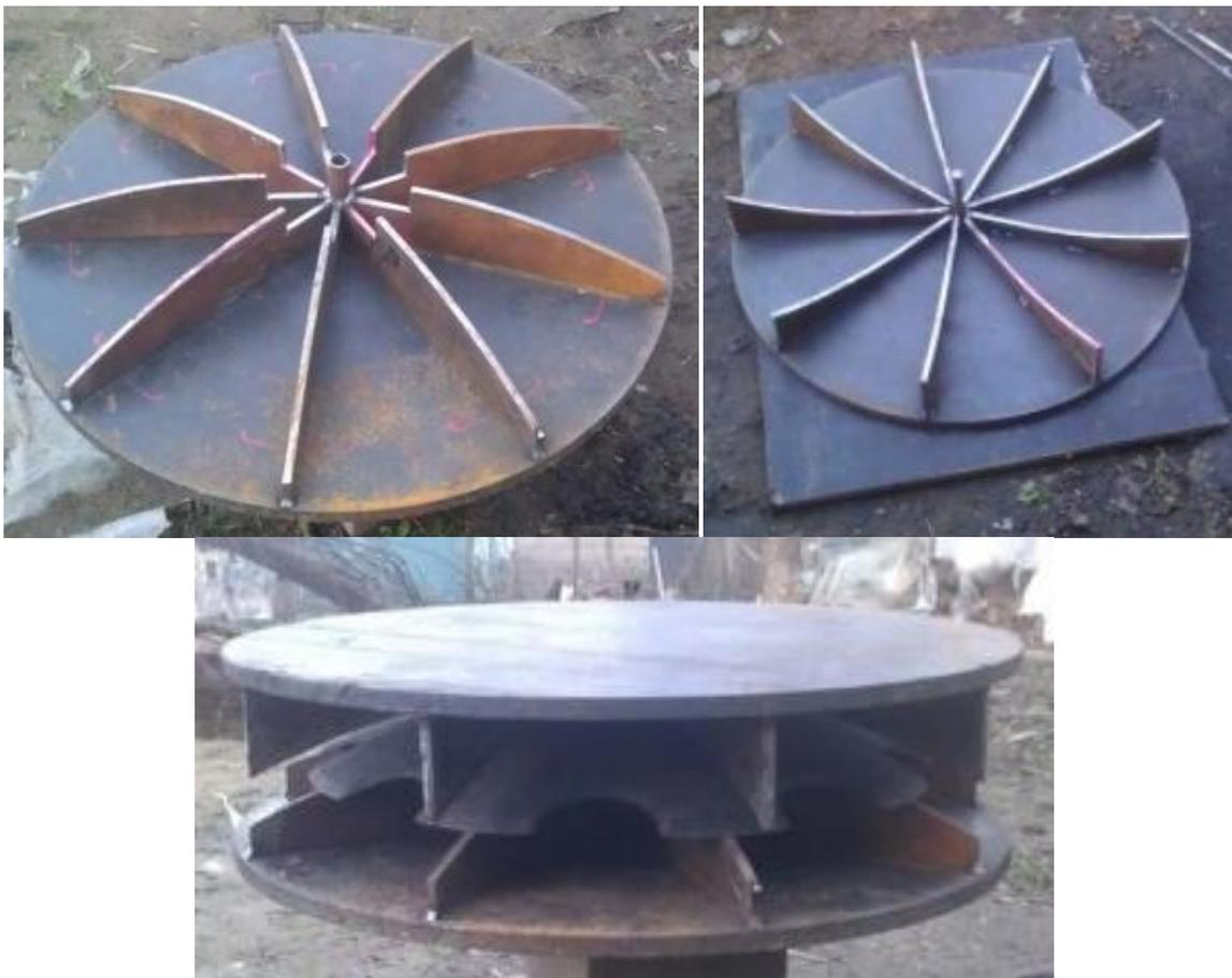
Рисунок 3.4 – Внешний вид пресс-формы для изготовления дисковых рабочих органов с изменяющимся радиусом кривизны
