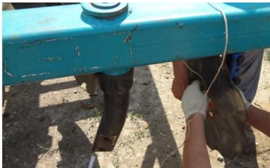
Рисунок 3.8 – Внешний вид процесса монтажа опытных режущих узлов
