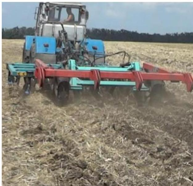
Рисунок 4.3 – Процесс экспериментального исследования удельной энергоемкости обработки почвы дисковыми рабочими органами с изменяющимся радиусом кривизны
