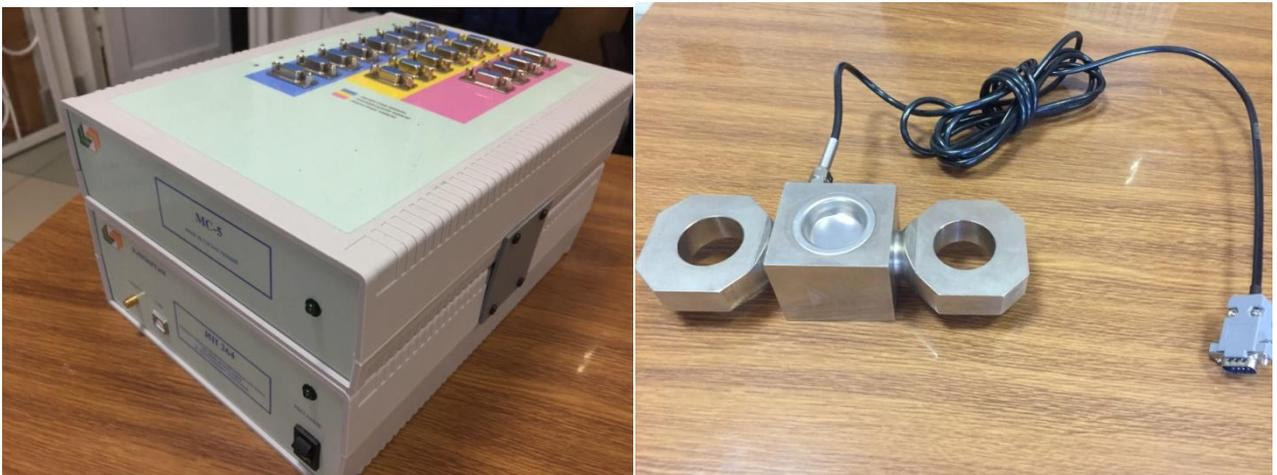
Рисунок 3.9 – Внешний вид измерительной информационной системы ИП-264
