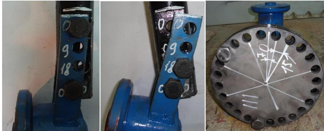
Рисунок 3.6 – Внешний вид стойки и подшипникового узла дискового рабочего органа для эксперимента
