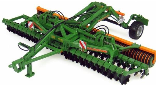
Рисунок 1.3 – Внешний вид компактной дисковой бороны Catros
