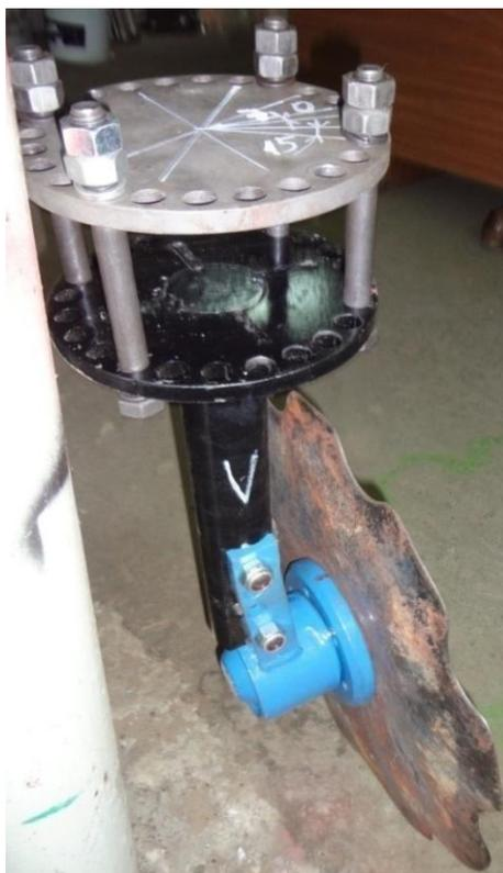
Рисунок 3.7 – Внешний вид опытного рабочего органа с изменяющимся радиусом кривизны
