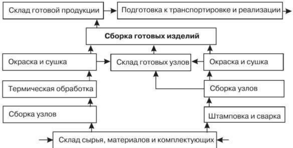
Рисунок 1 - Поточная диаграмма технологических процессов сборочного производства
