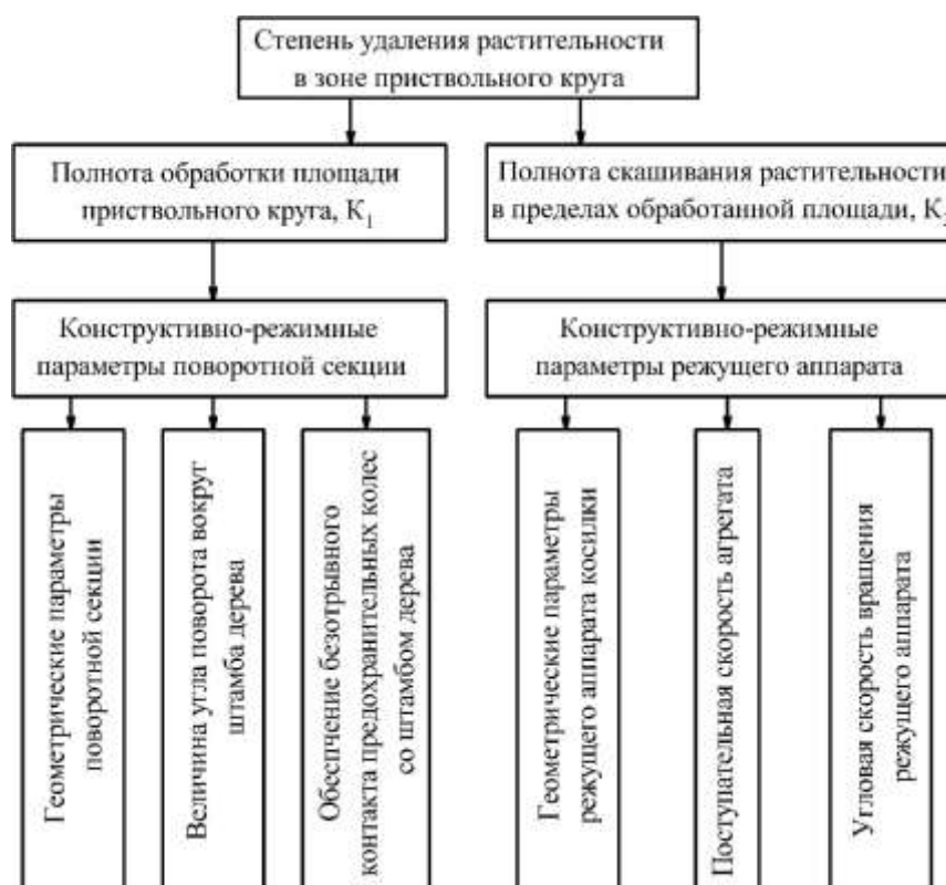
Рисунок 2.2 – Взаимосвязь конструктивно-режимных параметров косилки и степени удаления растительности в зоне приствольного круга.
