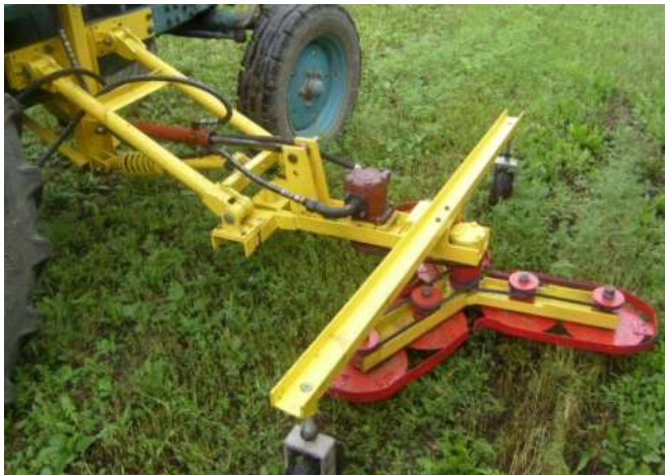
Рисунок 1.8 – Общий вид косилки КОН -6 с усовершенствованным механизмом навески
