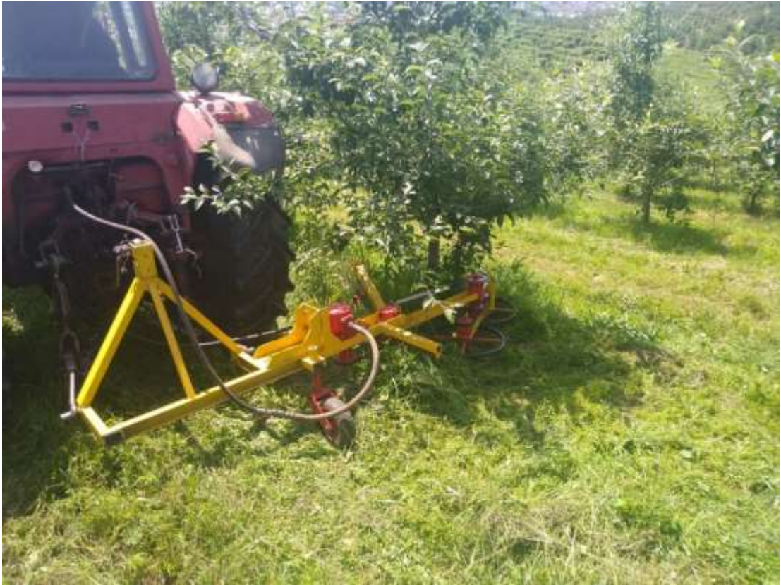
Рисунок 3.9 – Опытный образец косилки для обработки приствольных полос плодовых насаждений на террасированных склонах
