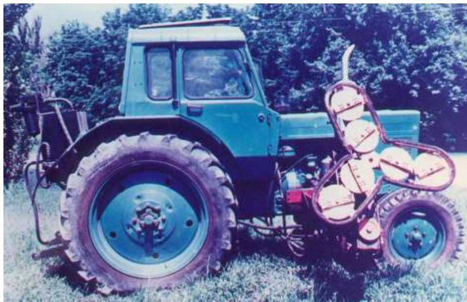
Рисунок 1.6 – Косилка-измельчитель КОИ-6 конструкции Северо-Кавказского научно-исследовательского института горного и предгорного садоводства.
