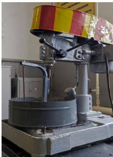
Рисунок 3.20 – Внешний вид экспериментальной лабораторной установки для исследования износа зубьев МФА
