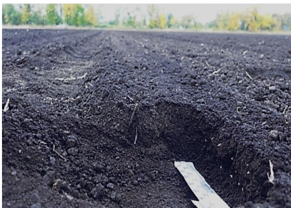
Рисунок 4.21 – Замеры заделки семян и удобрений и их распределение под слоем при посеве в полевых условиях
