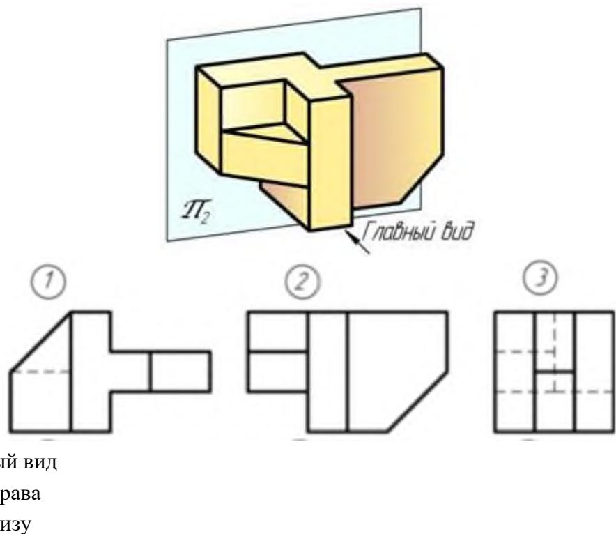
43. Установить соответствие. По заданным видам определить название каждого вида согласно проекционной связи
