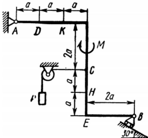
Жесткая рама, расположенная в вертикальной плоскости, закреплена в точке А шарнирно, а в точке В прикреплена или к невесомому стержню с шарнирами на концах, или к шарнирной опоре на катках. В точке С к раме привязан трос, перекинутый через блок и несущий на конце груз весом Р. На раму действуют пара сил с моментом М и силы, значение
