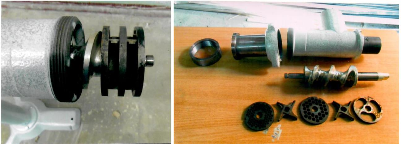
Рисунок 3.4 – Общий вид измельчающе-гомогенизирующего аппарата
