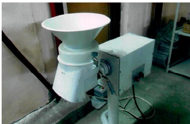
Рисунок 3.2 – Общий вид измельчителя с приводом (блочно-модульное исполнение)
