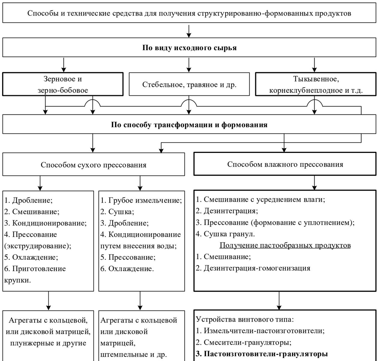
Рисунок 2.1 – Схема классификации способов и технических средств по приготовлению структурированно-формованных продуктов
