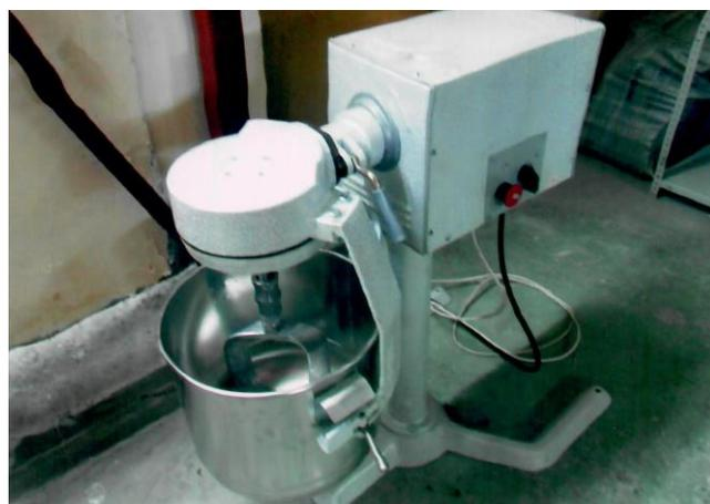
Рисунок 3.3 – Общий вид смесителя с приводом (блочно-модульное исполнение)
