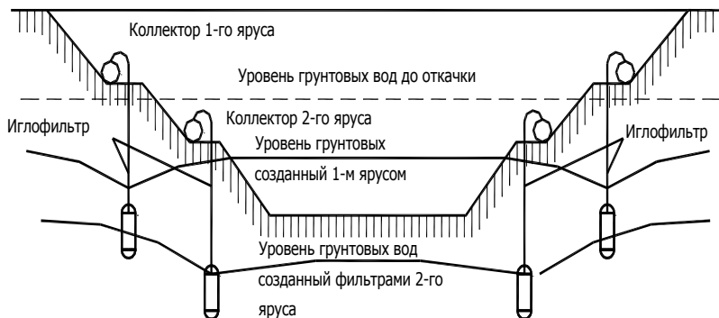
Рисунок 1.8 – Схема понижения уровня грунтовых вод двух-ярусной иглофильтровой установкой
