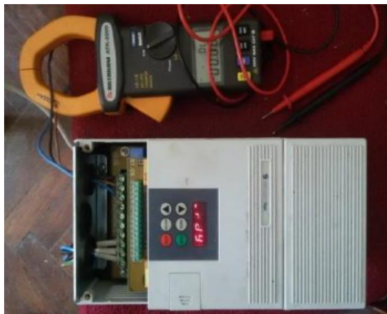
Рисунок 3.5 - Преобразователь частоты тока ELDI - 5.5 в комплекте с токовыми клещами «Актакон АТК - 2200»
