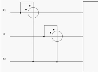
а)  $P_{\Sigma} = \sqrt{3} * (P_{w1} + P_{w2})$     б)  $P_{\Sigma} = \sqrt{3} * (P_{w1} - P_{w2})$     в)  $P_{\Sigma} = P_{w1} + P_{w2}$     г)  $P_{\Sigma} = P_{w1} - P_{w2}$
