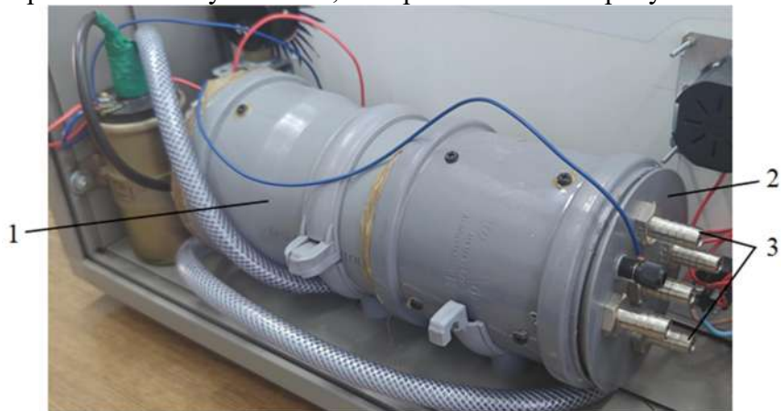
1 – корпус озонатора; 2 – выходной блок озонатора; 3 – патрубки для подключения воздухопроводов
