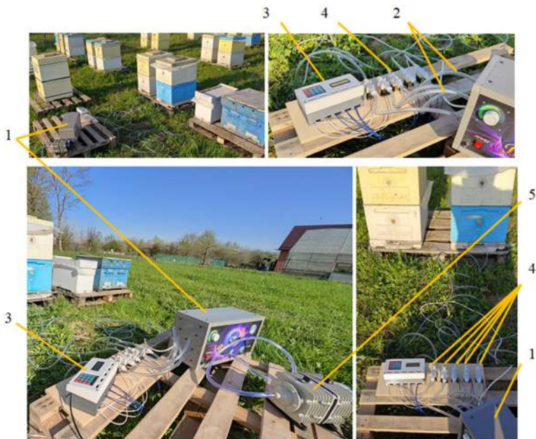
Рисунок 12 – Фотографии полевых исследований разработанной установки для групповой обработки озона пчелиных ульев.
