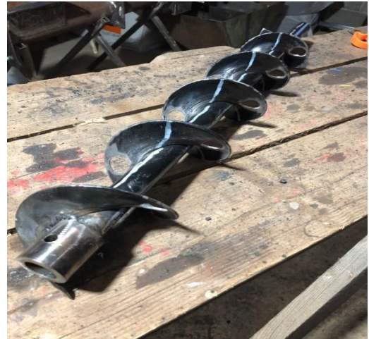
Рисунок 3 – Общий вид шнековой мешалки с пересыпными отверстиями
