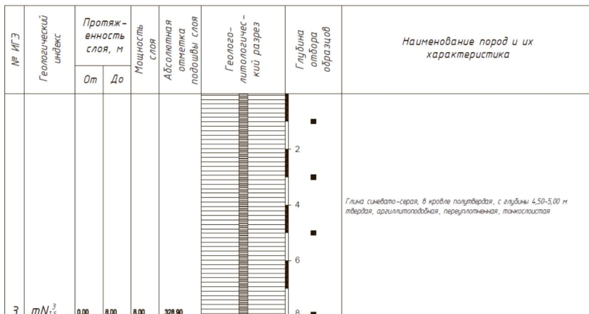
Рисунок 3.5 – Геологический разрез в створе мелиоративного водозабора
