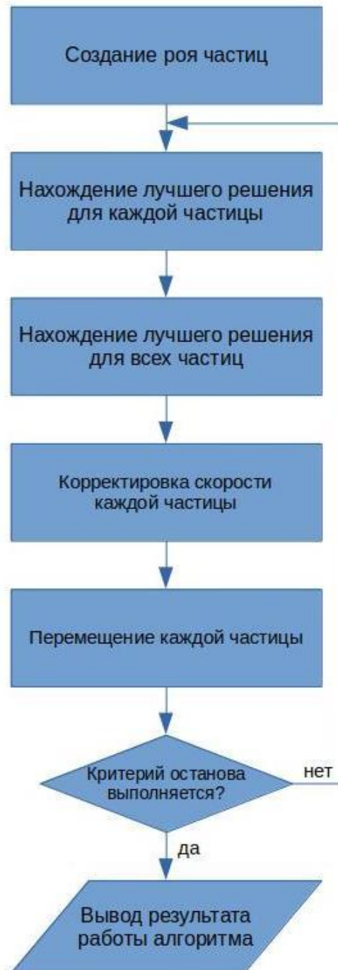
Рисунок 2.4 - Блок-схема алгоритма роя частиц
