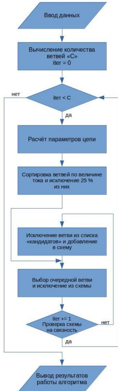
Рисунок 2.1 – Блок-схема модернизированного алгоритма обратного удаления
