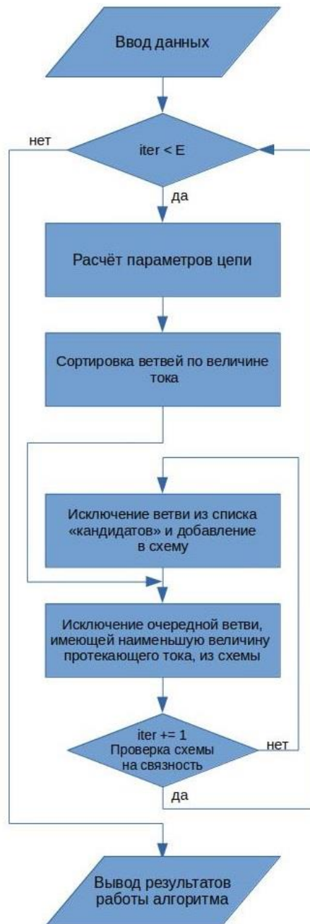
Рисунок 2.2 – Блок-схема классического алгоритма обратного удаления
