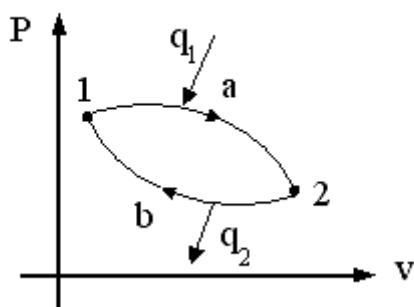
Термический КПД цикла 1-a-2-b-1, показанного на графике, определяется соотношением....
