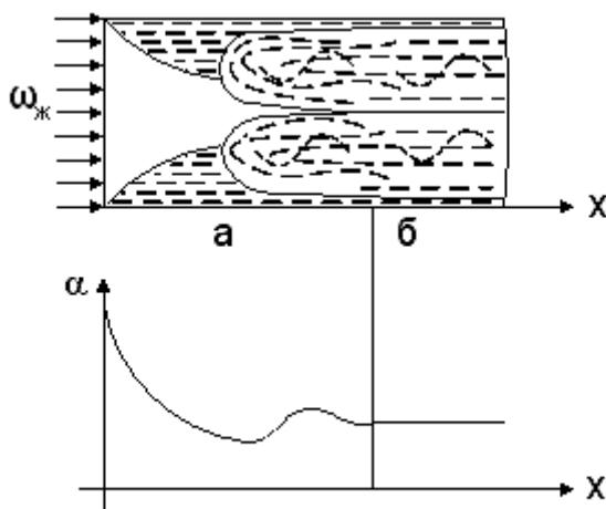
При расчете средней теплоотдачи от стенки трубы к протекающему по ней теплоносителю, изображеному на рисунке, за определяющий размер принимается...
