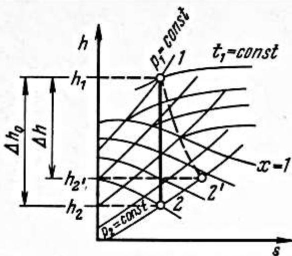
Соотношение между сухости пара в конце процессов равновесного и неравновесного расширения пара в сопле, представленном на графике, равно...
