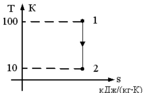
$T_1 = 100\text{K}$ ,  $T_2 = 10\text{K}$ ,  $v_1 = 1 \text{ м}^3/\text{кг}$ ,  $k = 2$ . В точке 2 адиабатного процесса, представленного на графике, удельный объем равен....
