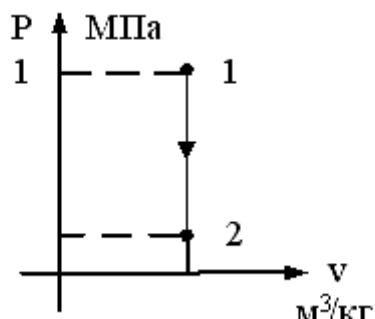
$T_1 = 1000\text{K}$ ,  $T_2 = 100\text{K}$ ,  $P_1 = 1 \text{ МПа}$ . В точке 2 изохорного процесса, представленного на графике, давление равно...
