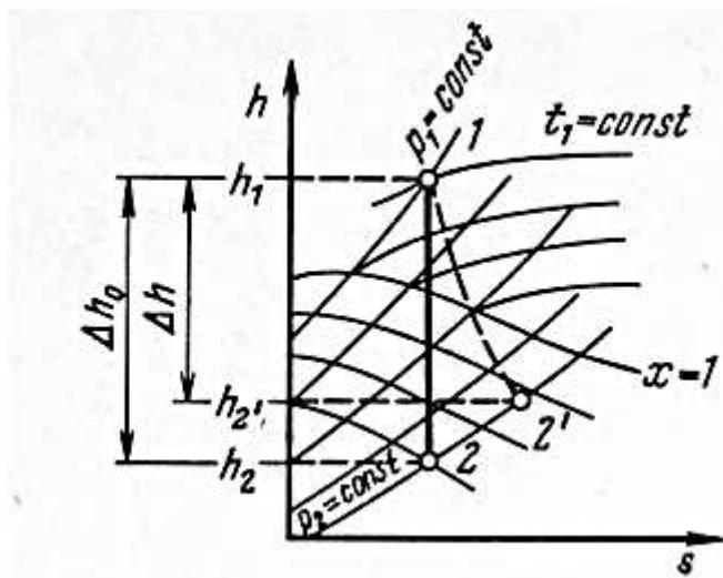
При одинаковом перепаде давления  $P_1 - P_2$  соотношение между скоростями истечения пара в сопле в равновесном  $C_2$  процессах, представленных на графике, имеет вид....
