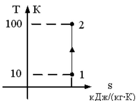
$T_1 = 10 \text{ К}$ ,  $T_2 = 100 \text{ К}$ ,  $P_1 = 1 \text{ кПа}$ ,  $\kappa = 2$ . В точке 2 адиабатного процесса, представленного на графике, давление равно\_\_\_\_кПа.
