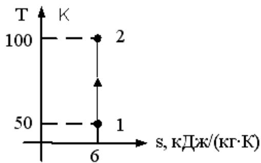
Подводимая теплота в процессе 1-2 идеального газа, изображенном на графике, в Дж/кг равна...
