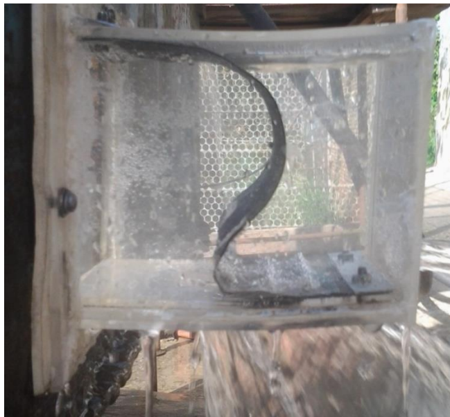
Рисунок Б4 – Лабораторный регулятор в работе при H = 18 см и d = 0,7 см
