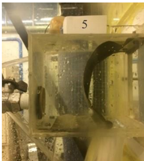
Рисунок 4.4 – Состояние ленточного запорного органа при определенном технологическом режиме
