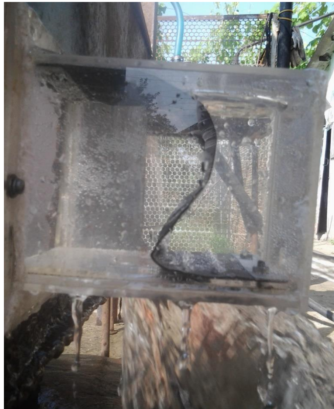
Рисунок Б6 – Лабораторный регулятор в работе при H = 30 см и d = 0,7 см
