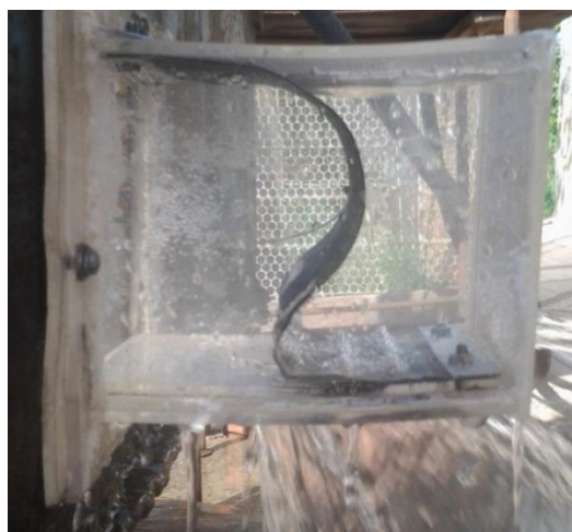
Рисунок 3.4 – Лабораторный эксперимент при рабочем напоре в 18 см
