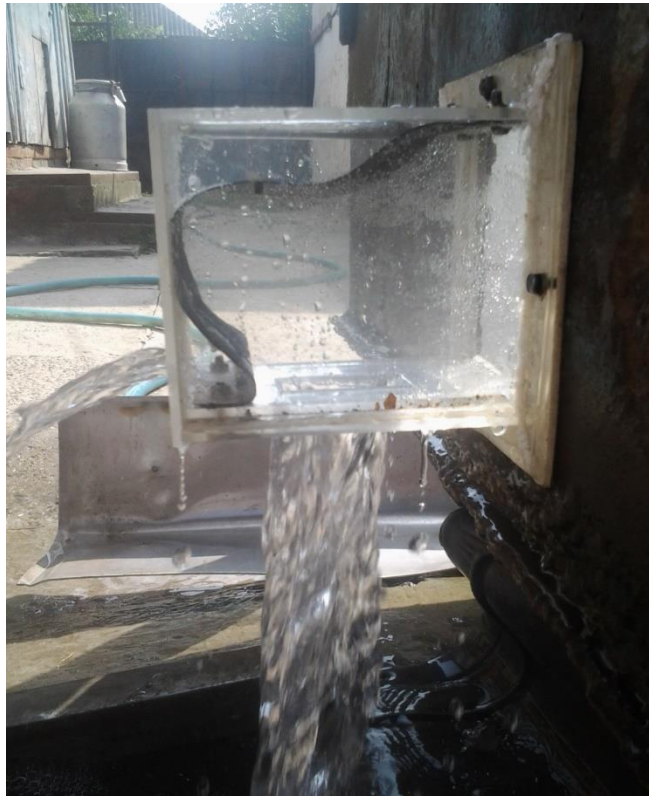
Рисунок Б3 – Лабораторный регулятор в работе при H = 18 см и d = 0,6 см
