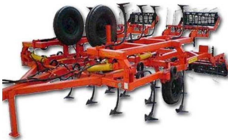
Рисунок 1.20 – Общий вид агрегата комбинированного чизельного АКЧ-4
