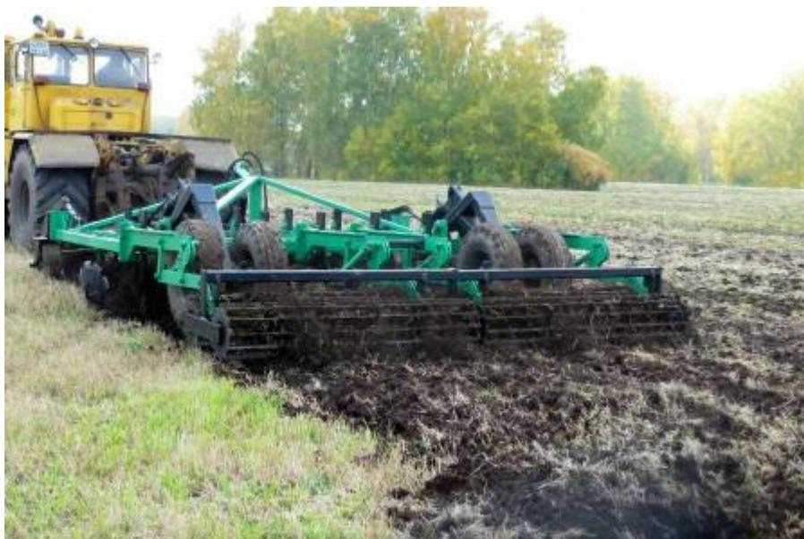
Рисунок 1.21 – Многофункциональный комбинированный почвообрабатывающий агрегат
