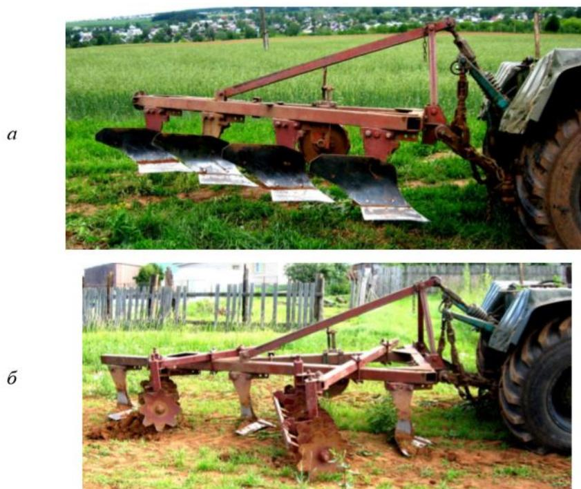
Рисунок 1.26 – Общий вид плуга-плоскореза ППН-4-35/3-70
