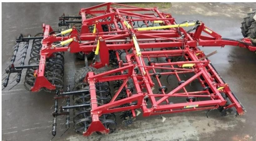
Рисунок 1.13 – Агрегат почвообрабатывающий многофункциональный АПМ-6
