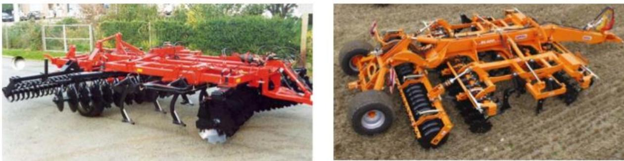
Рисунок 1.4 – Общий вид дисковой бороны *DXRV* и *SL DTD*
