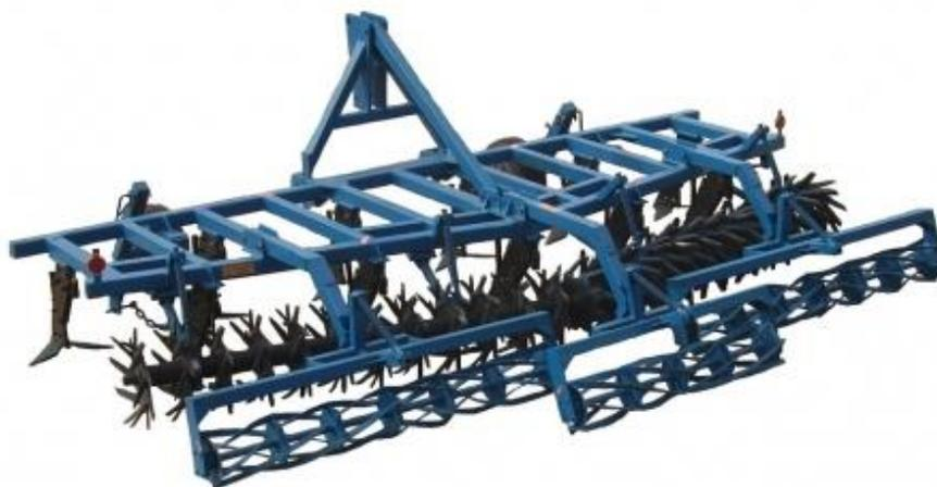
Рисунок 1.15 – Общий вид агрегата универсального комбинированного ПАУК-4.5
