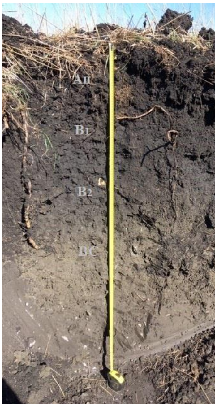
Рисунок 25 – Профиль черноземов южных карбонатных слабосолонцеватых средне солончаковатых слабогумусных среднемоштных среднесмытых легкоглинистых на третичных глинах
