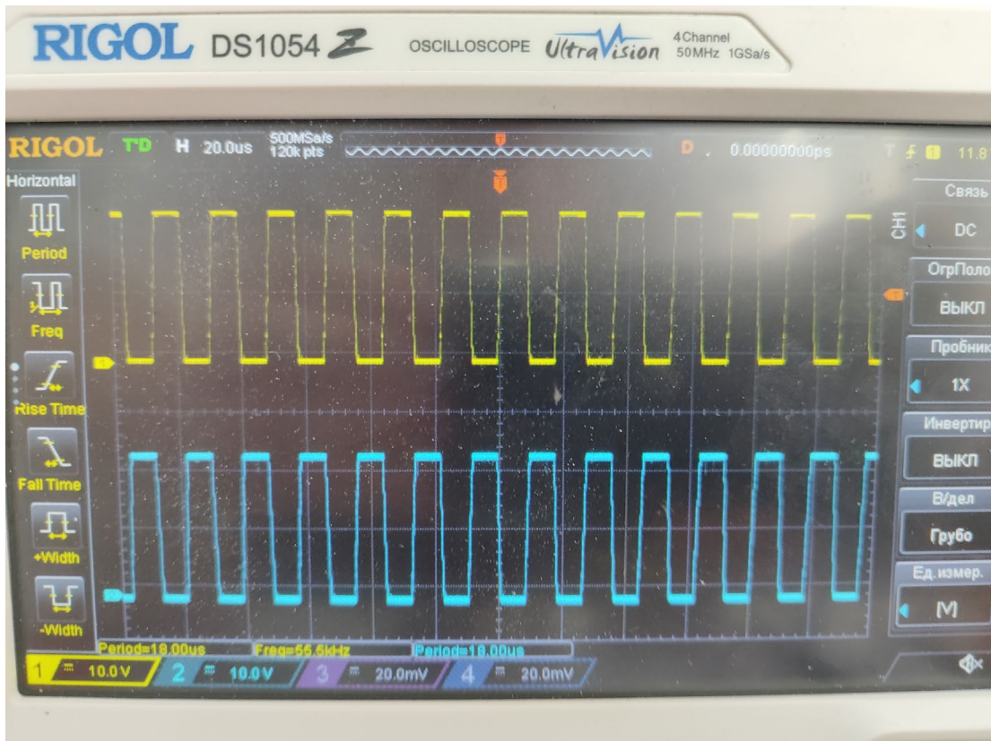
Рисунок 4.4 – Форма управляющих сигналов транзисторами VT1 и VT2 инвертора
