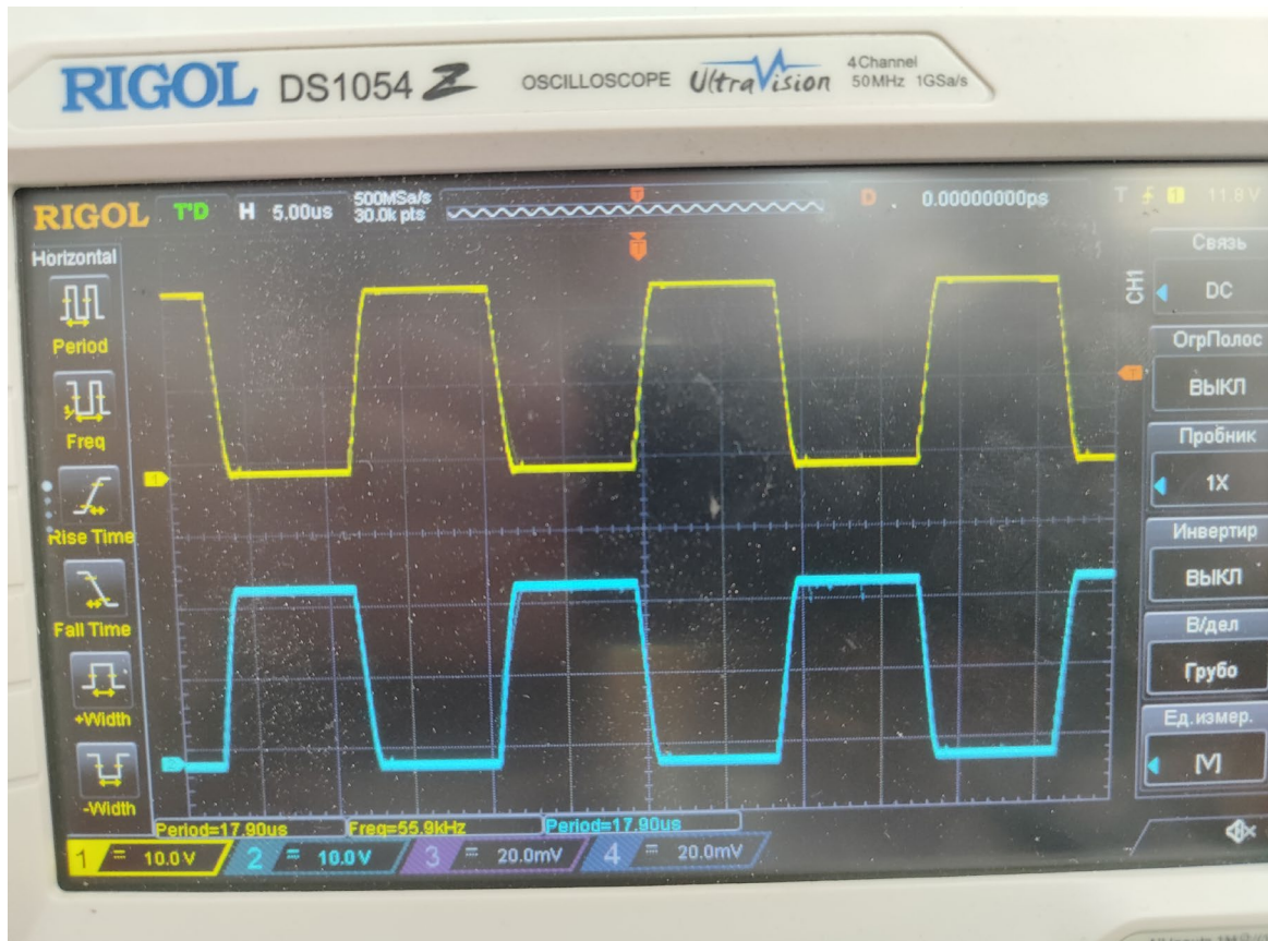
Рисунок 4.3 – Форма сигналов датчиков полярности напряжения ДПН1 и ДПН2
