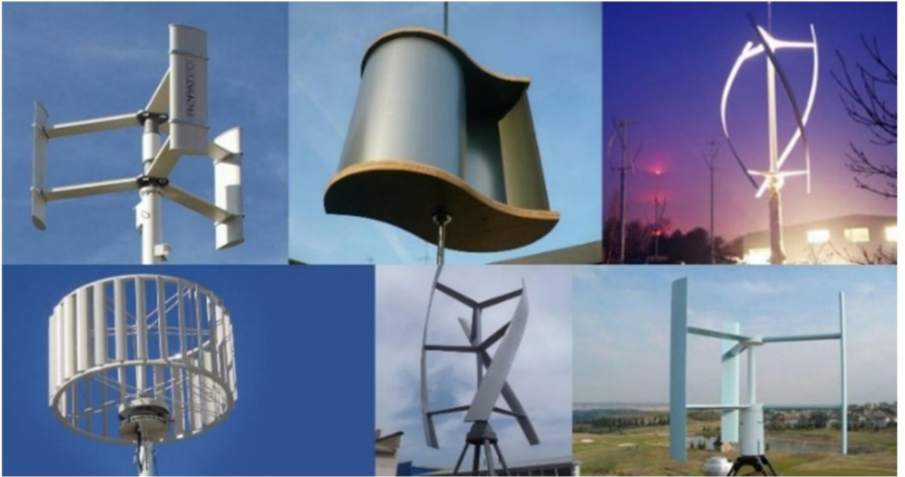
Рисунок 1.4 – Конструкции ВЭУ с вертикальной осью
