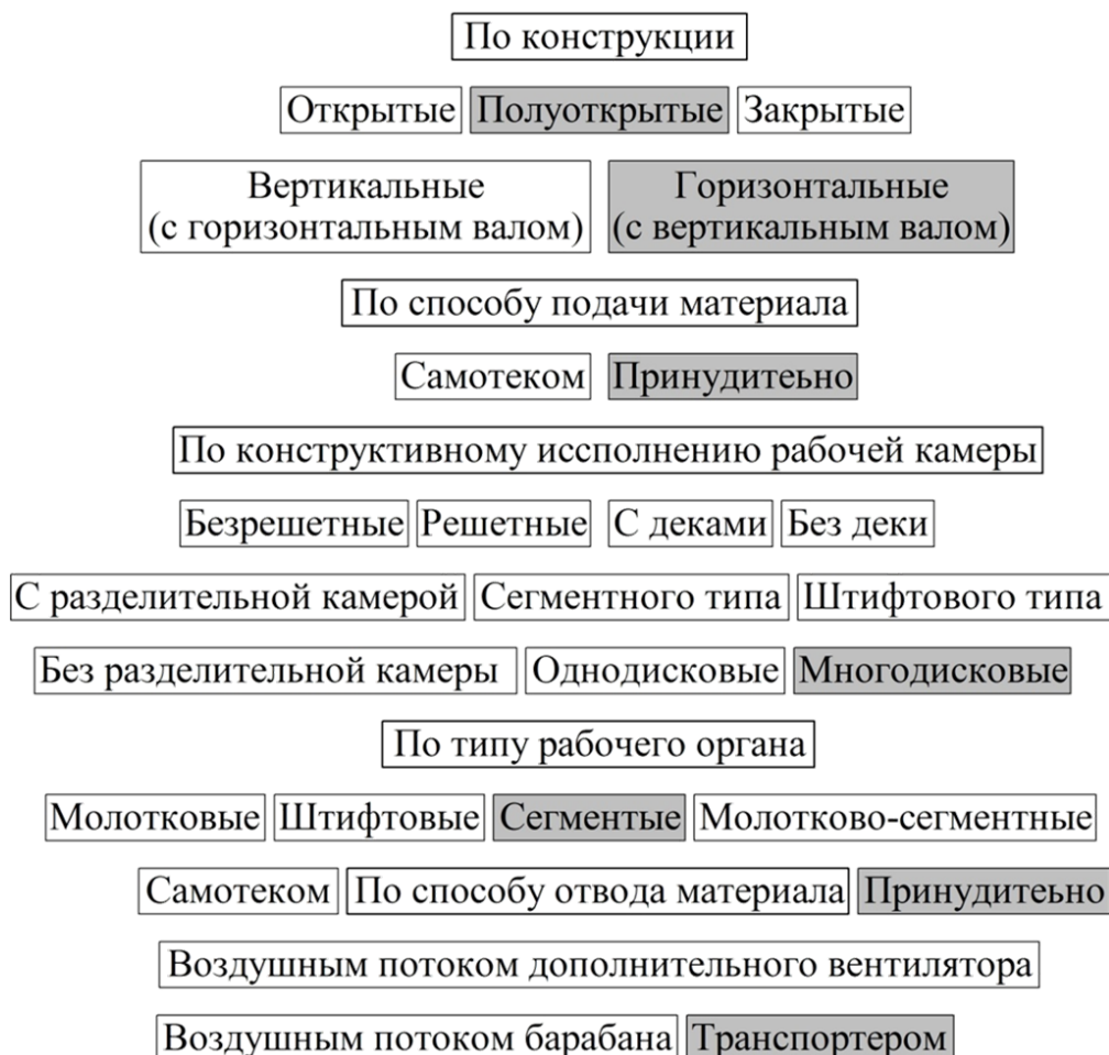
Рисунок 1.1 - Блок схема, классификация измельчителей длинностебельных кормов [99]
