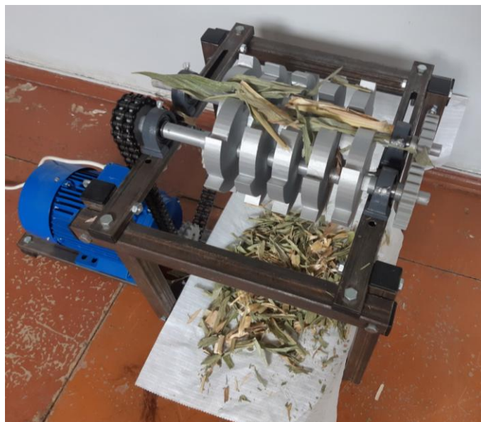
Рисунок 3.4 - Общий вид экспериментального измельчителя длинностебельных кормов
