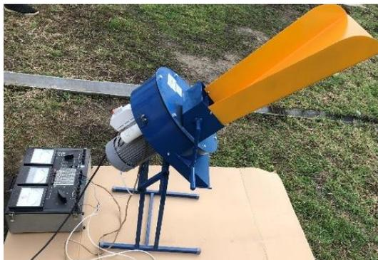
Рисунок 4 – Внешний вид экспериментальной установки измельчителя с рабочим органом молотково-сегментного типа
