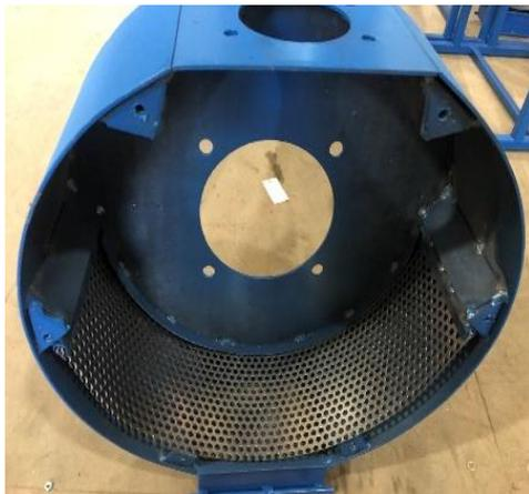
Рисунок 7 – Внешний вид сепарирующего решета
