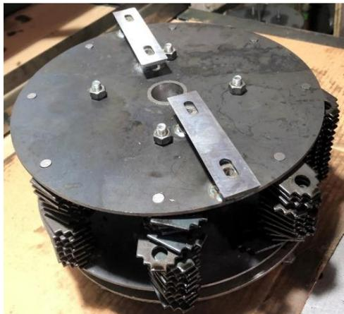
Рисунок 6 – Внешний вид измельчающего рабочего органа
