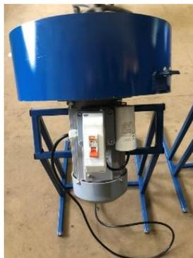
Рисунок 5 - Внешний вид электропривода измельчающего рабочего органа
