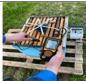
Рисунок 11. – Внешний вид улья с установленным вибратором
