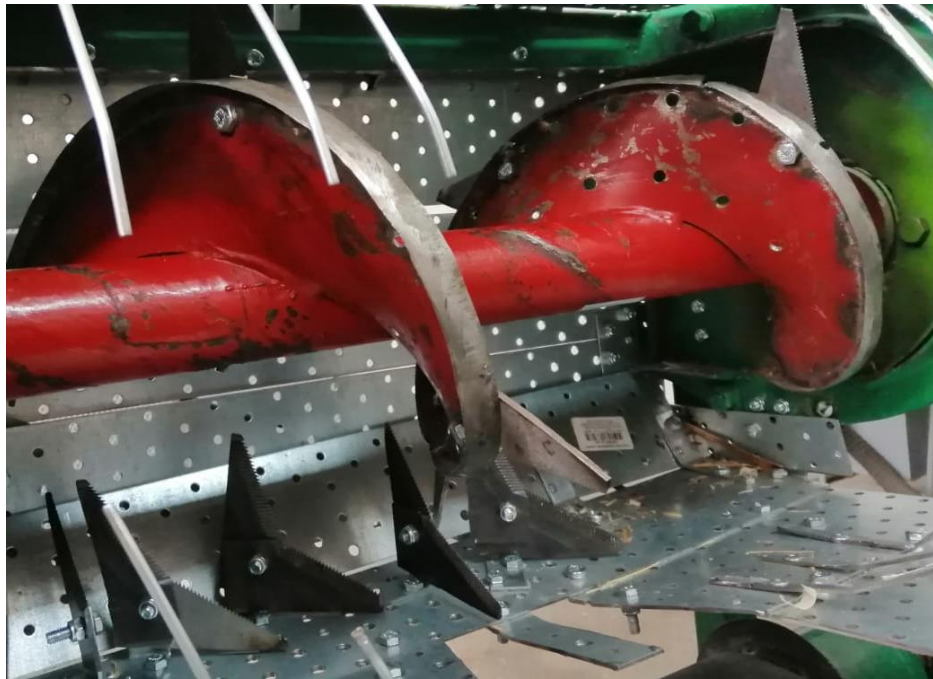
Рисунок 3.14 – Вариант 2 устройства для среза и измельчения
