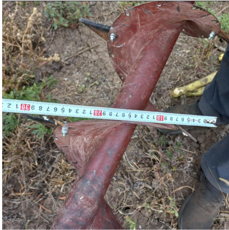
Рисунок 3.24 – Регулировка шага сегментов
