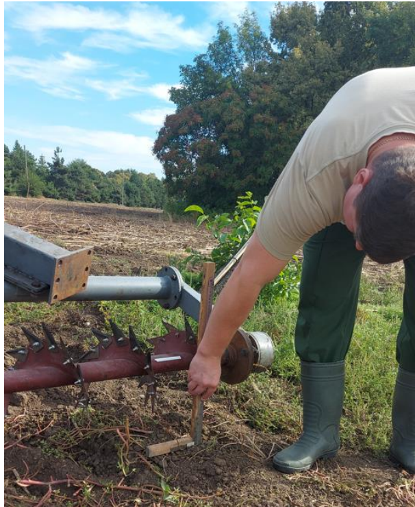
Рисунок 3.22 – Регулировка высоты среза
