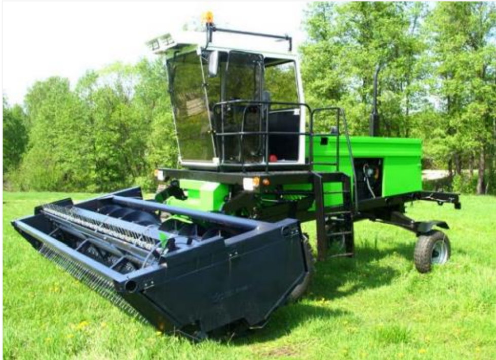
Рисунок Г19 – Жатка для уборки кормовых культур SH-025 в агрегате с самоходной косилкой-плющилкой «Мещера Е-403»
