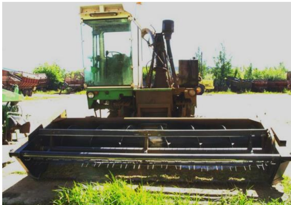
Рисунок Г25 – Жатка для уборки кормовых культур SH-42 в агрегате с самоходным кормоуборочным комбайном E-281 «Марал-125»
