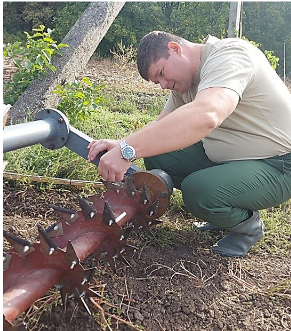
Рисунок 3.23 – Фото регулировки угла наклона сегментов
