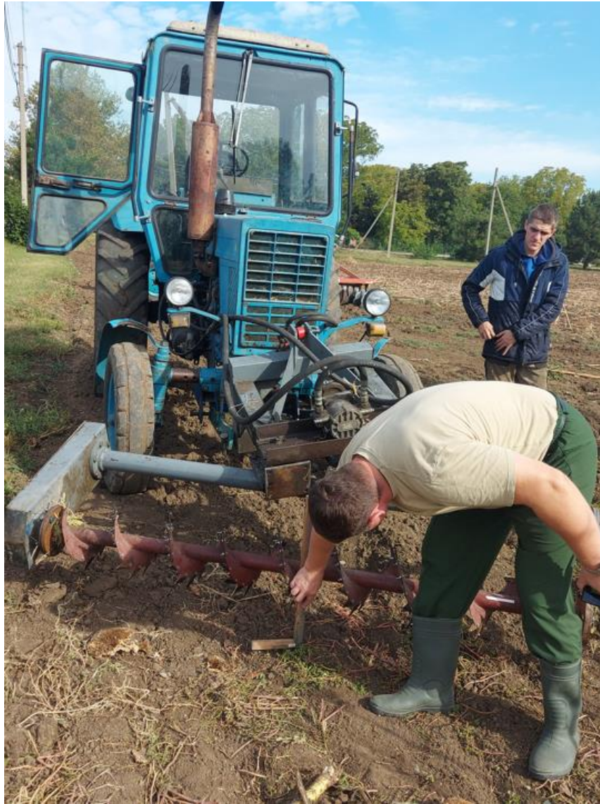
Рисунок 3.25 – Регулировка высоты среза
