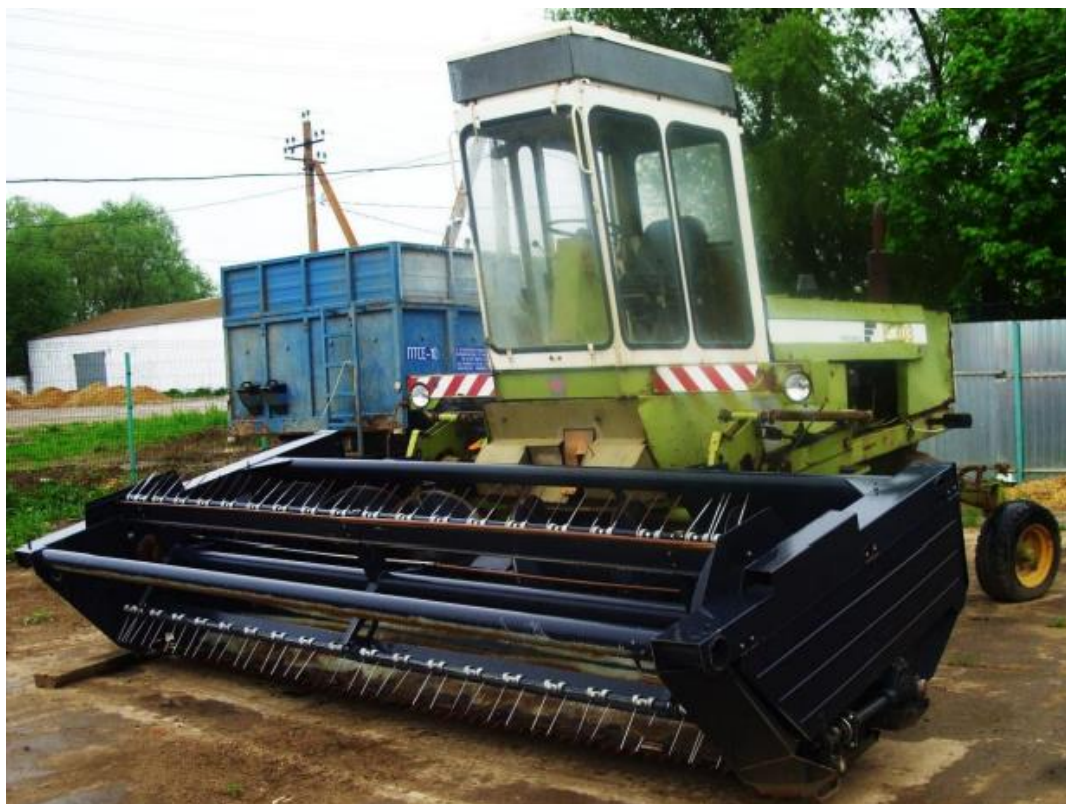
Рисунок Г26 – Жатка для уборки кормовых культур Е-023 в агрегате с самоходной косилкой-плющилкой Е-303
