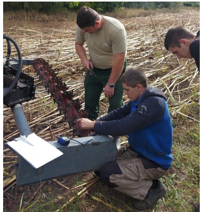
Рисунок 3.23 – Фото регулировки угла наклона сегментов
