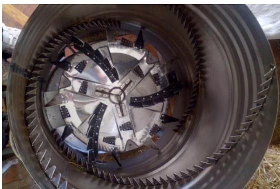
Рисунок 3.3 - Общий вид измельчителя стебельных кормов, заготовленных в прессованном виде
