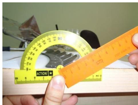
Рисунок 3.8 - Угол атаки горизонтальных зубчатых измельчающих элементов
