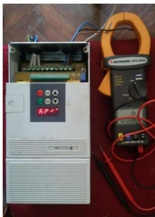
Рисунок 3.7 - Преобразователь частоты тока ELDI – 5.5 в комплекте с токовыми клещами «Актакон АТК - 2200»
