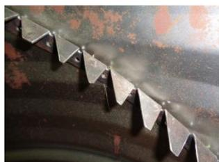
Рисунок 3.5 - Шнековая навивка приемного бункера
