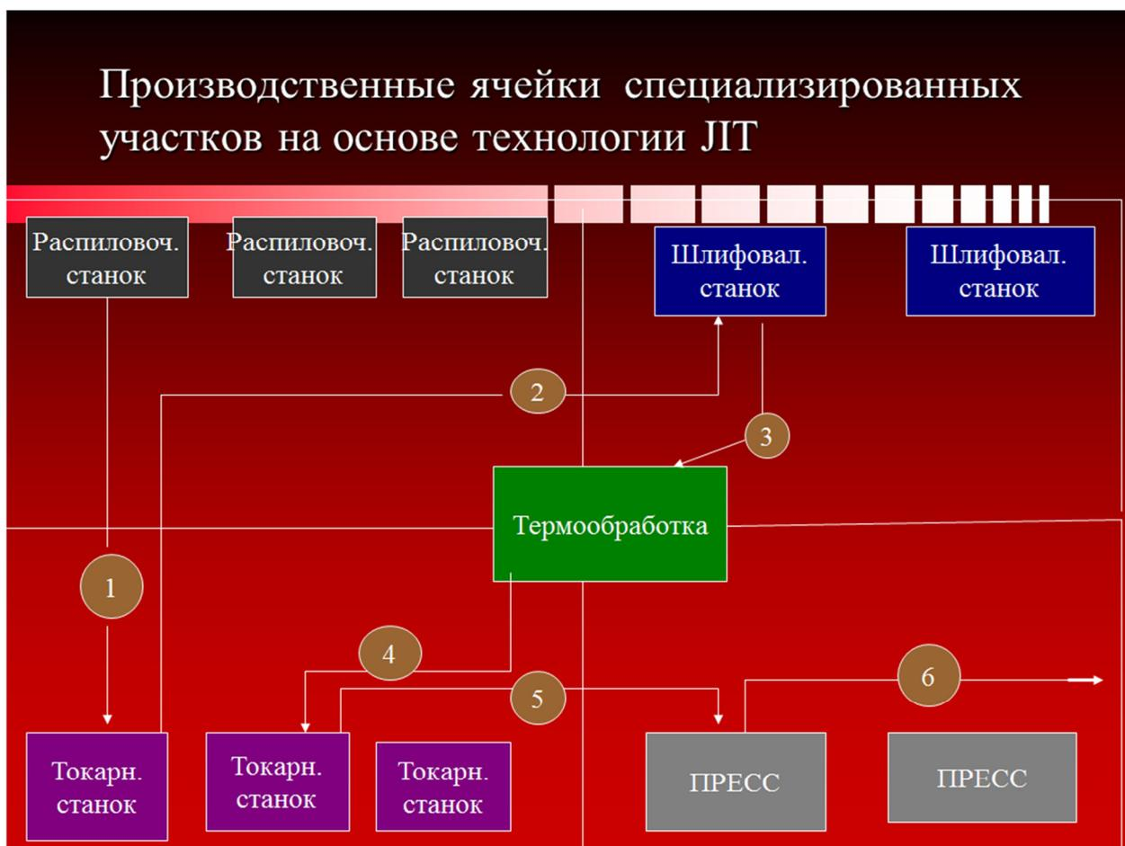
Рис. 1 – производственные ячейки на основе работы ЛТ.
