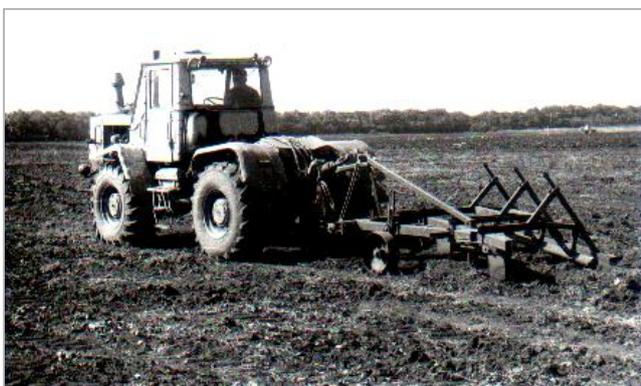
Комбинированный почвообрабатывающий агрегат КАО-2 для основной безотвальной и поверхностной обработки почвы
