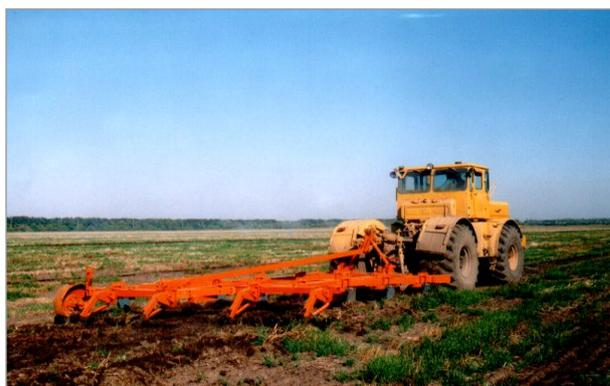
Комбинированный почвообрабатывающий агрегат КАО-10 для основной безотвальной и поверхностной обработки почвы
