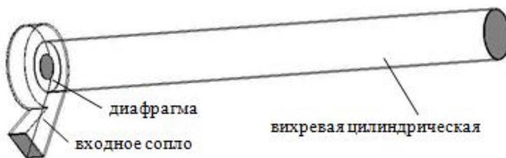
Рисунок 1 – Схема кавитационного теплогенератора
