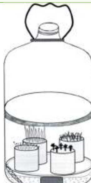
Рисунок 4 – Переносной контейнер для биотестирования почвы
