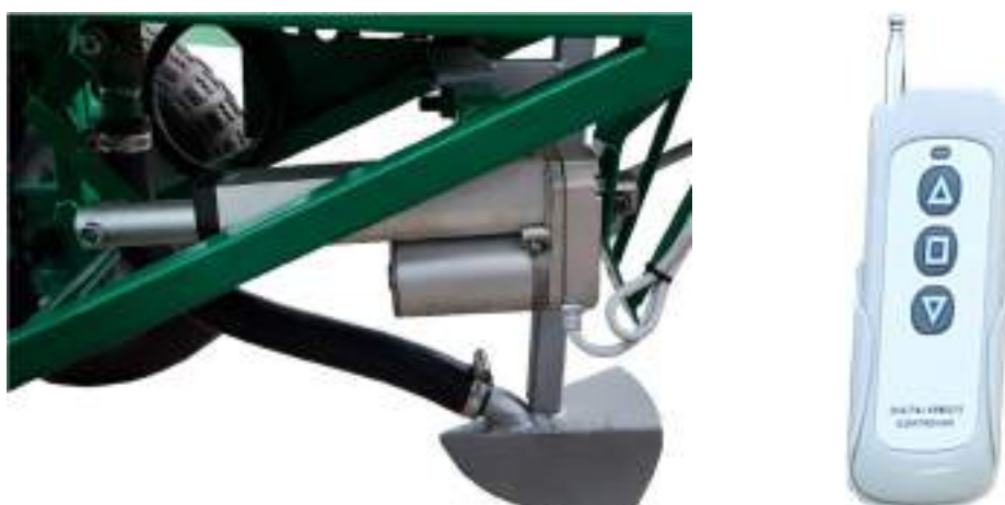
Рисунок 2 – Электропривод заслонки с пультом дистанционного управления
