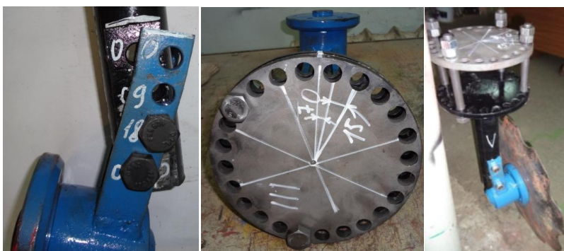
Рисунок 5 – Внешний вид стойки, подшипникового узла и опытного рабочего органа с изменяющимся радиусом кривизны
