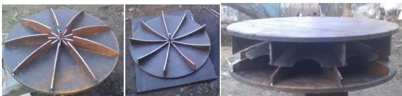
Рисунок 4 – Внешний вид пресс-формы для изготовления дисковых рабочих органов с изменяющимся радиусом кривизны
