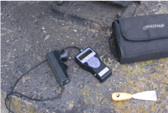
Рисунок 3.2 – Измеритель прочности бетона ОНИКС-2.52
