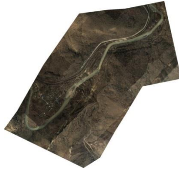
Рисунок 2.18 – Фрагменты цифровой аэрофотосъемки каналов внутрихозяйственной сети рисовых систем: а) построенный по энергии импульса отражения, полученной с помощью воздушного сканера лазерных систем контроля; б) построенный по энергии импульса отражения, полученных с помощью воздушного сканера.
