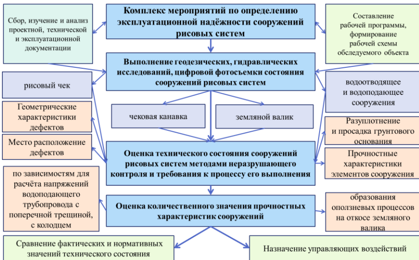
Рисунок 5.1 – Функциональная структура комплекса мероприятий диагностики технического состояния сооружений рисовых систем по показателям работоспособности
