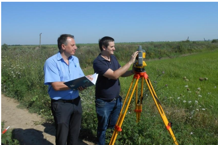
Рисунок 2.11 – Выполнение комплекса мероприятий контроля работоспособности длительно эксплуатируемых конструкций внутрихозяйственных систем орошения тахеометрической съемкой
