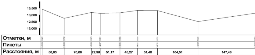
Рисунок 2.4 – Фрагмент продольного профиля земляного валика рисового чека на участке ПК0+00,00 – ПК16+20,00
