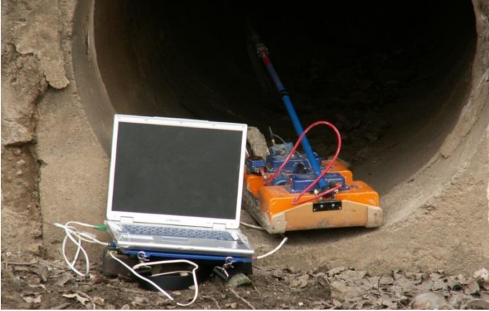
Рисунок 3.1 – Радиотехнический прибор, подповерхностного зондирования георадар ОКО-2
