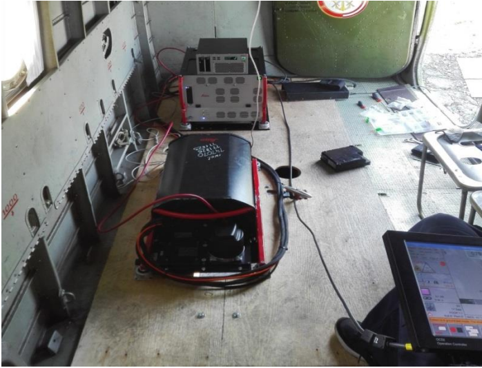
Рисунок 2.17 – Воздушный лазерный сканер Leica ALS 70 – CM в работе при выполнении аэросъемочных работ на самолете АН-2
