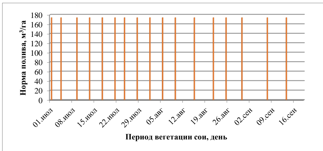
Рисунок 5.4 –График режима орошения сои при КО и ВПО для 80 % НВ
