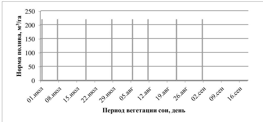
Рисунок Д.1 – График режима орошения сои при КО и ВПО для 70 % НВ
