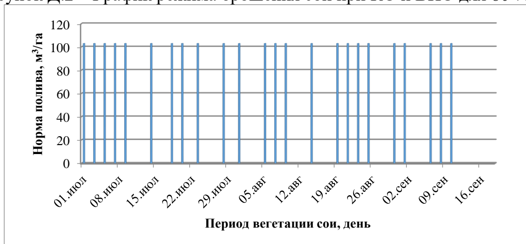
Рисунок Д.2 – График режима орошения сои при КО и ВПО для 80 % НВ
