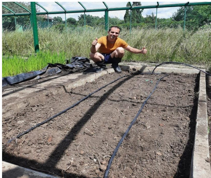
Рисунок 3.7 – Лизиметр с капельным орошением
