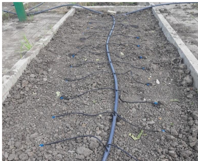
Рисунок 3.8 – Лизиметр с внутривпочвенным орошением
