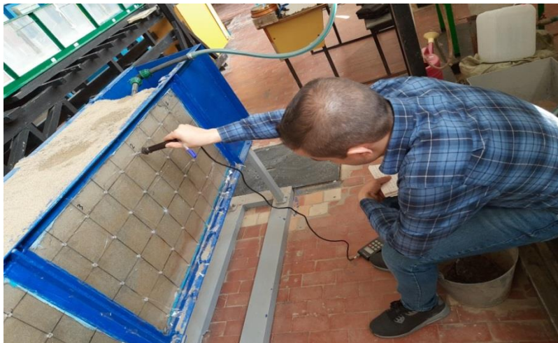
Рисунок 2.3 – Измерение влажности почвогрунта на модели
