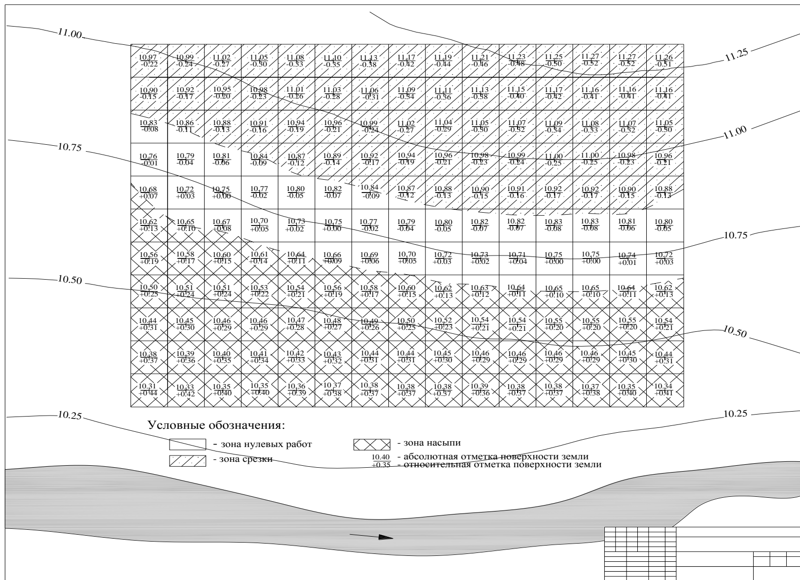
Рисунок 3 – План террасы с выделением зон работ
