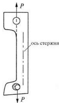
Рисунок 7.17 – Пример внецентренного растяжения (сжатие)
