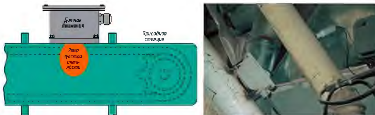
Рисунок 4.91 - Места установки датчика движения скорости РДД
