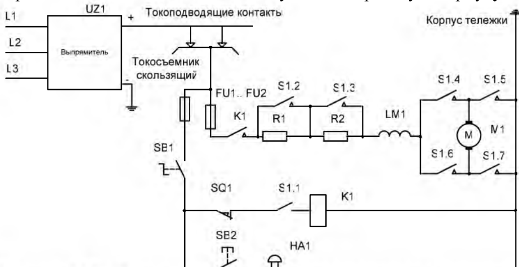
Рисунок 4.97 - Схема принципиальная электропривода контактной тележки на постоянном токе
