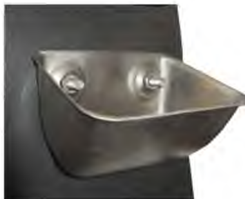
Рисунок 4.2– конструкция нории типа НЦ и вид ковша
