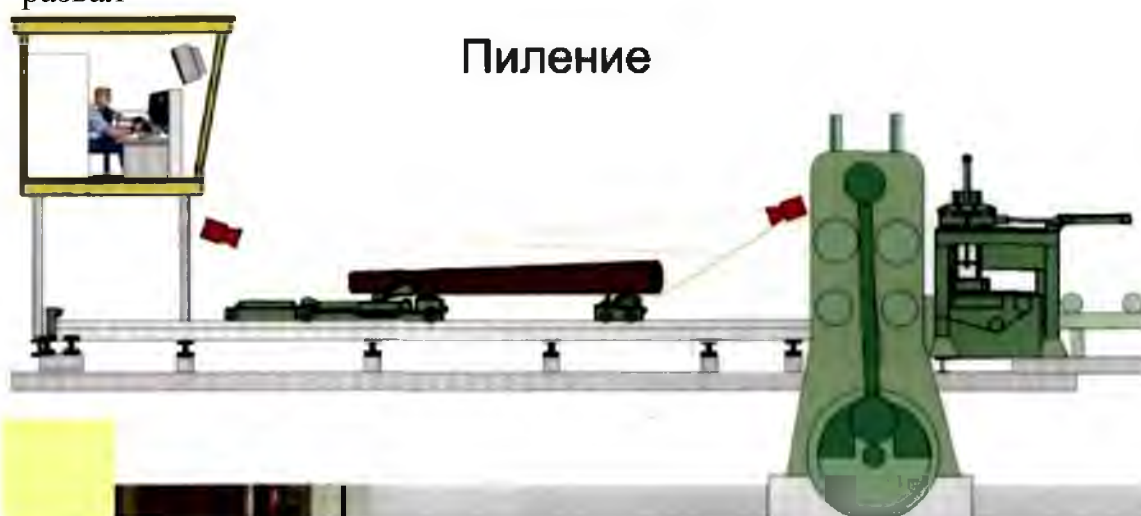
Рисунок 5.41 - Схема распиловки бревен на лесопильной раме с лазерной настройкой.
