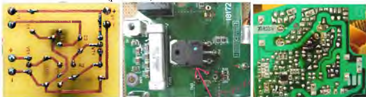
Рисунок 1.10 – Пример выхода из строя элементов из-за неправильного выбора эксплуатационного режима
