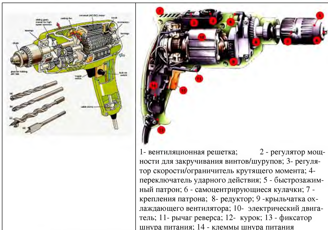
Рисунок 6.21– Кинематические схемы электродрелей
