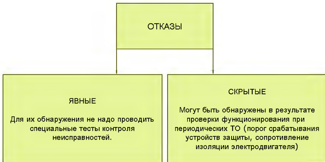
Рисунок 1.13 – Классификация отказов по способу обнаружения
