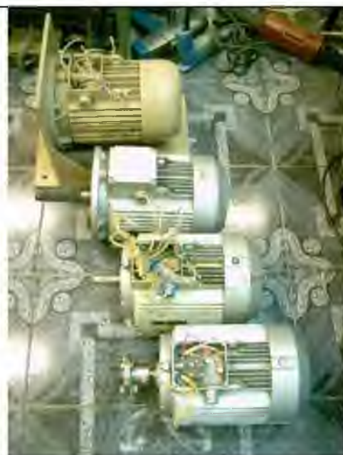
Рисунок 6.47 - Опытные образцы асинхронных генераторов в габарите двигателей АИР 100 L6
