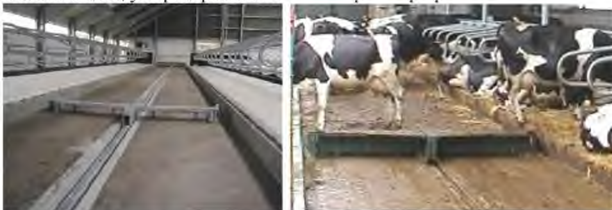
Рисунок 4.19 - Вид рабочего процесса скреперной установки УСГ
