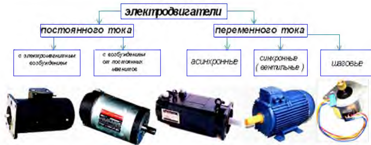
Рисунок 5.52– Типы электрических машин, применяемых в электроприводах станков
