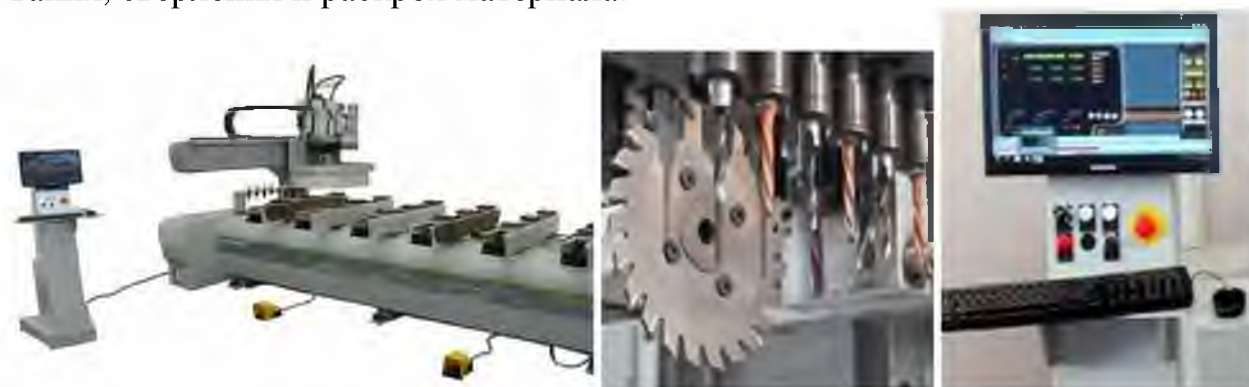
Рисунок 5.77 - Внешний вид обрабатывающего центра EASY W, его рабочие органы, панель управления
