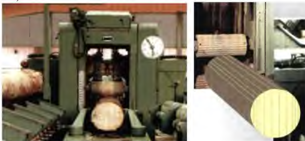
Рисунок 5.40 - Вертикальные лесопильные рамы и схема распиловки бревен в развал
