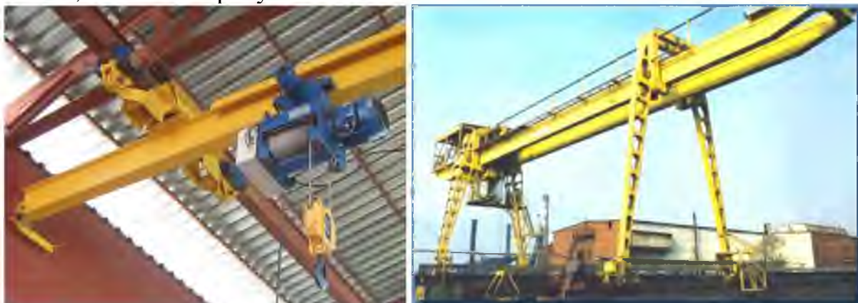
Рисунок 4.44 – Внешний вид кран-балки и мостового крана Технологическая схема мостового крана приведена на рисунке 4.45.
