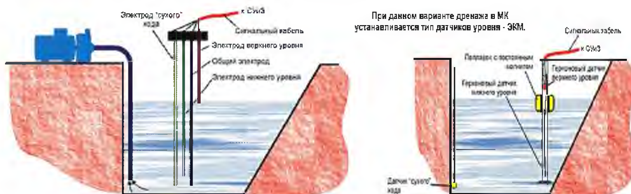
Рисунок 2.53– Установка датчиков при откачке дренажных вод.
