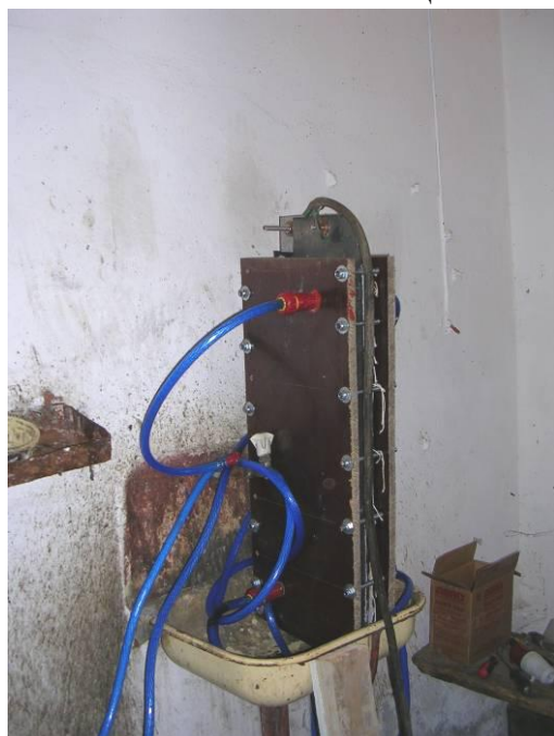
Рисунок 7.14- Внешний вид электроактиватора с блоком управления
