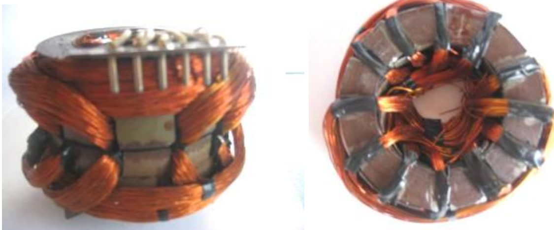
Рисунок 7.6-Индукционный регулятор для питания электроприводов в птичниках.
