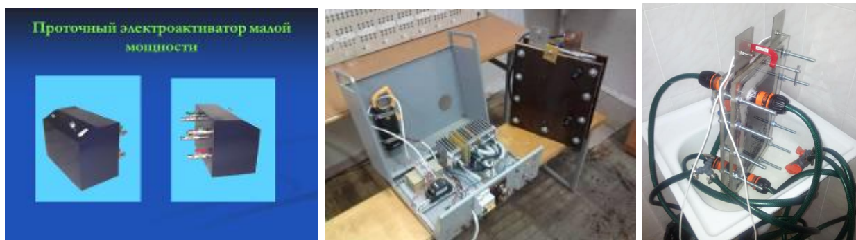
Рисунок 5.2- Макетные и действующие образцы электроактиваторов водных растворов
