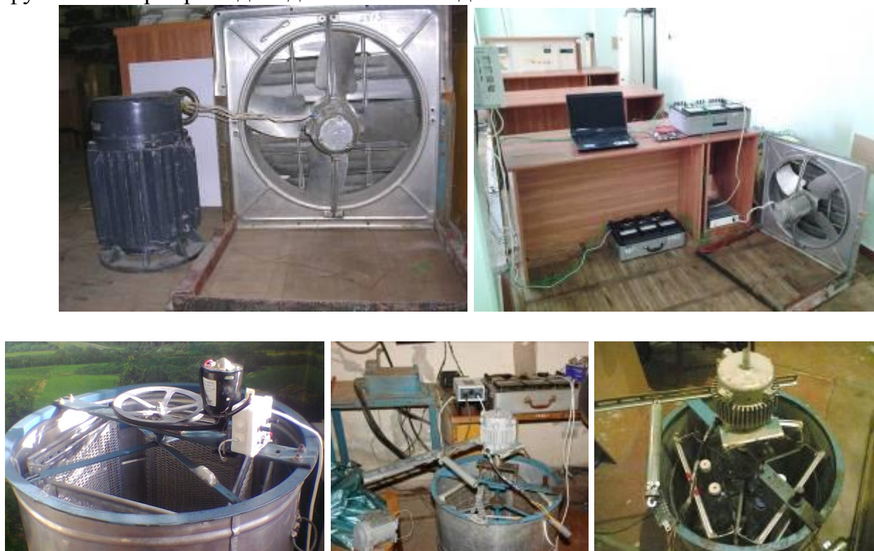
Рисунок 5.3- Изображение оборудования по исследованию регулятора производительности вентилятора и центрифуга с электроприводом для откачки меда.
