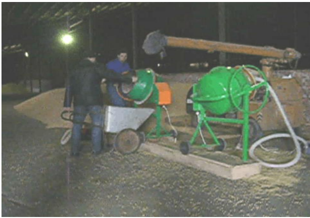
Рисунок 7.8 - Технологический процесс обработки сои озоном
