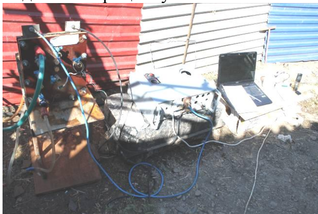
Рисунок 7.24- Оборудование для получения электроактивированного раствора
