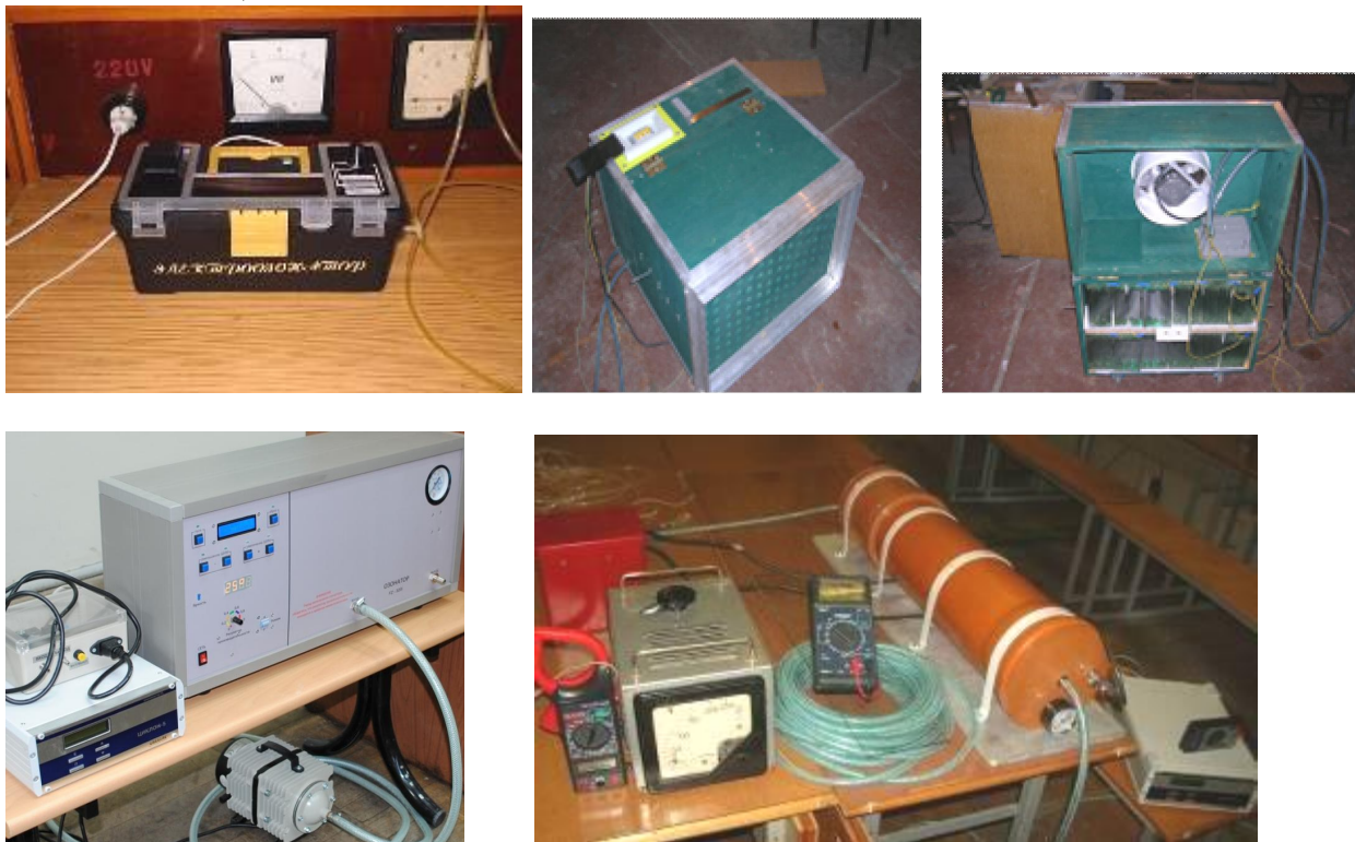
Рисунок 5.1- Макетные образцы озонаторов с измерительным оборудованием
