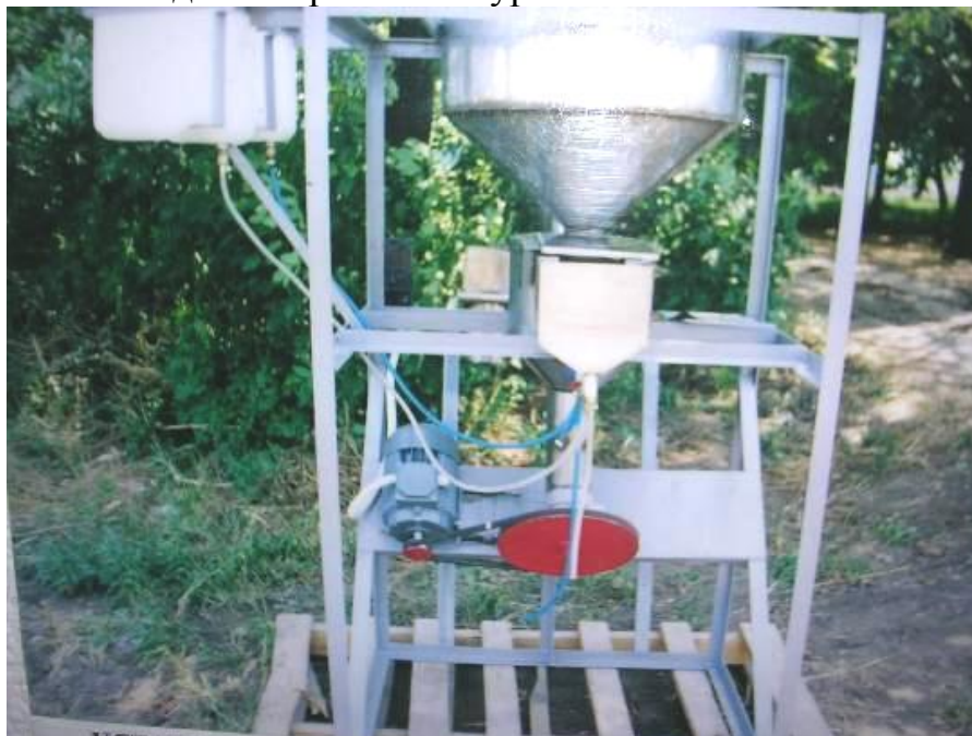
Рисунок 7.10 – Установка для предпосевной обработки семян электроактивированными растворами
