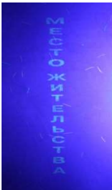
Рис. 48. Надпись, проявляющаяся в ультрафиолетовом диапазоне на шестой, восьмой и девятой страницах паспортов, выданных до 2007 г.
