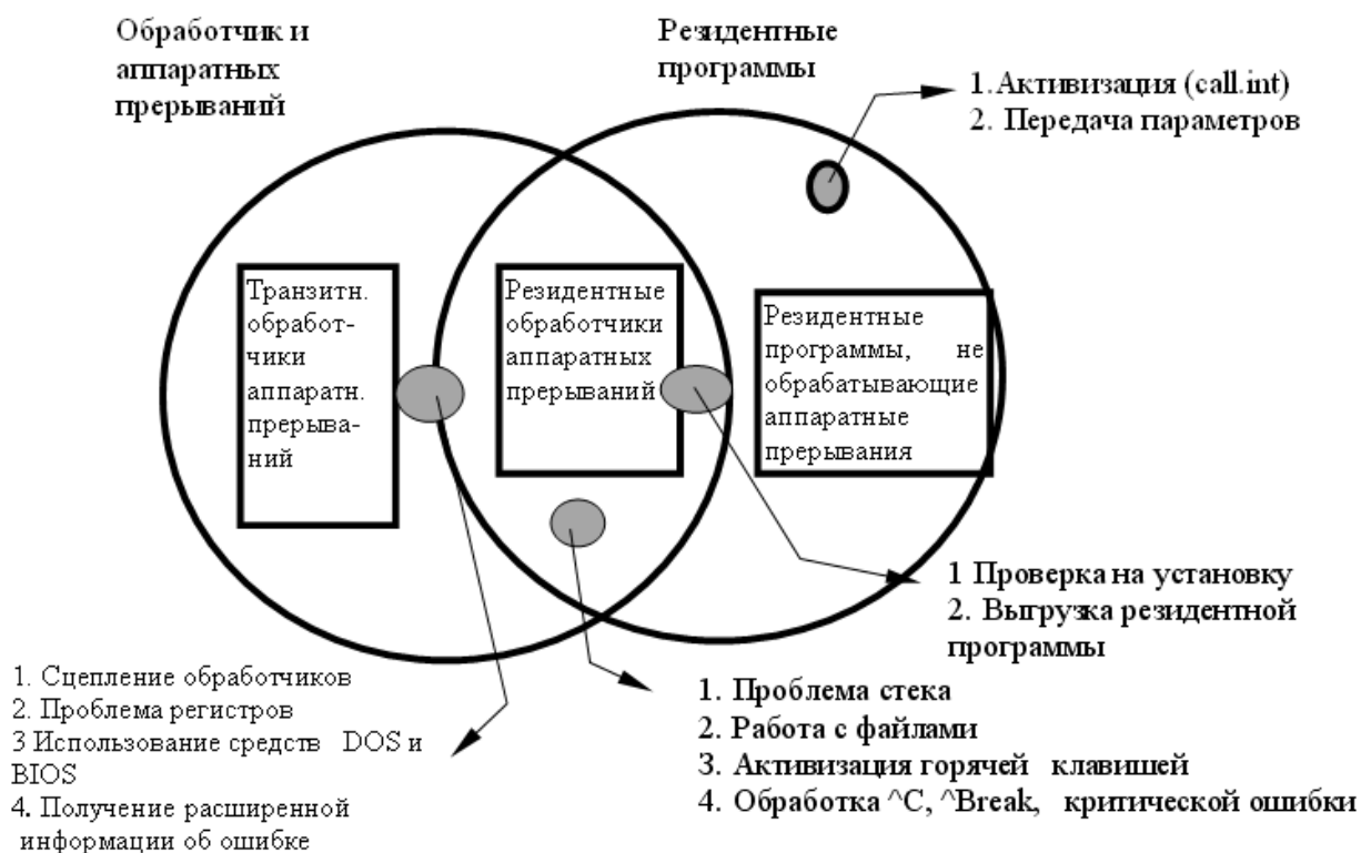
Рисунок 5.1 – Проблемы, возникающие при разработке обработчиков аппаратных прерываний и резидентных программ.
