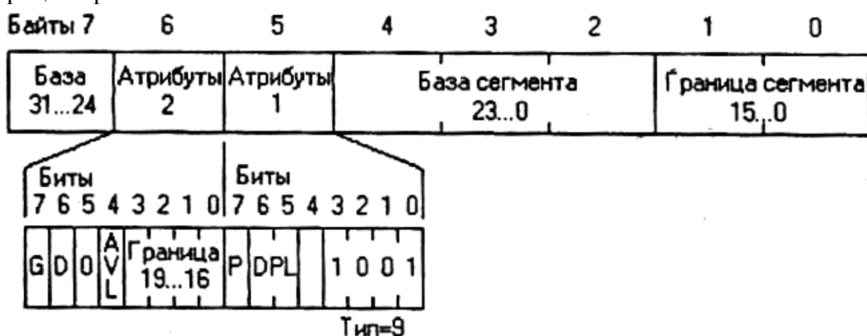
Рисунок 6.1 – Формат системного дескриптора, описывающего TSS для МП 386 и 486.
