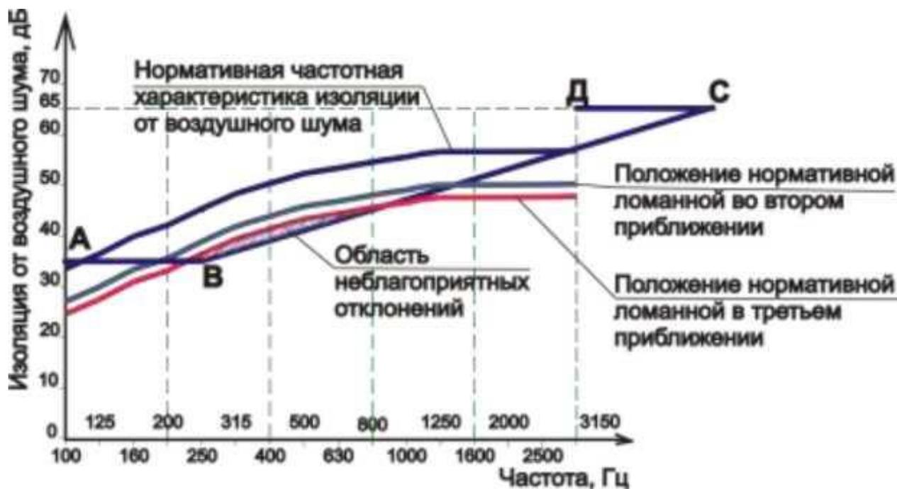
Рисунок 2 - Выполнение приближений в расчете звукоизоляции
