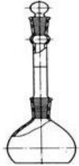
Рисунок 6.1 – Пикнометр
